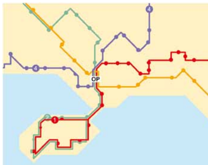
Figur 19 Illustrasjon av en løsning der alle linjer samles i ett felles omstigningspunkt (OP).
