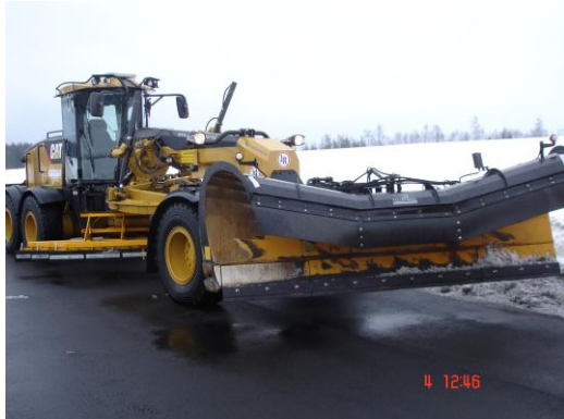
Uttesting av nytt utstyr for mekanisk fjerning av snø og slaps. Foto: Torgeir Vaa
