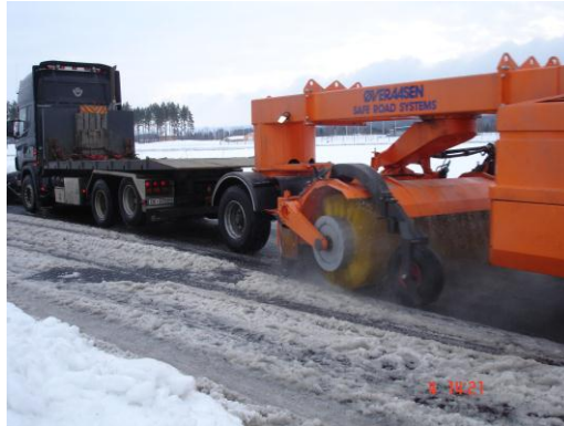
Uttesting av nytt utstyr for mekanisk fjerning av snø og slaps. Foto: Torgeir Vaa
