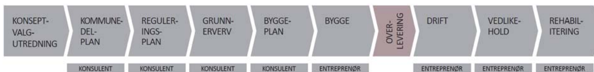
Fig. 1. De ulike fasene i et vegprosjekt. Angivelse av “konsulent” og “entreprenør” gir et bilde av hvor eksterne er involvert som tjenesteleverandør.
