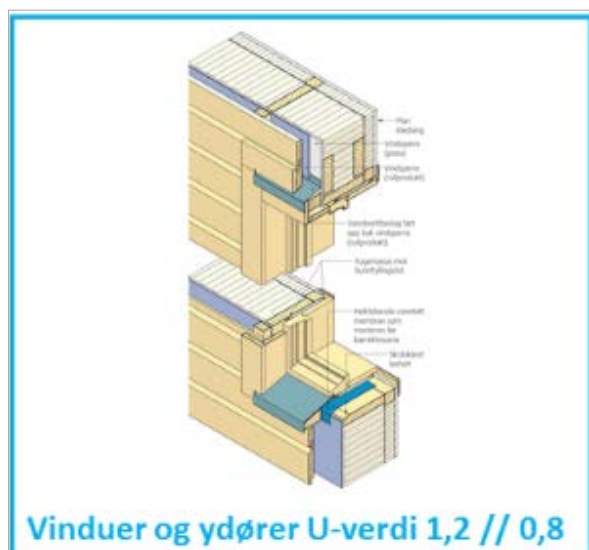
Figur 15 – Illustrasjon av vindu i vegg (Kilde: Byggforskerien 523.701 Innsetting av vindu i vegger av bindingsverk)
