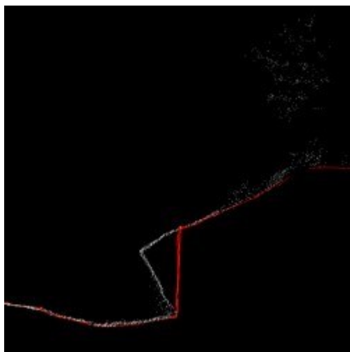
Figur 3.3.4.4-4 Viser eksempel på utilfredsstillende DTM (bilbårne laserdata).
