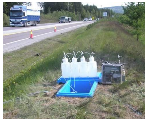
Figur 19. Venstre bilde viser prinsipp for uttak av jordvannprøver (renset overvann) med vakumsonder montert i filtermassen i bunn filtergrøft. Høyre bilde viser beholdere for oppsamling av jordvannprøver, vakumpumpe står til høyre (Ill./foto COWI).
