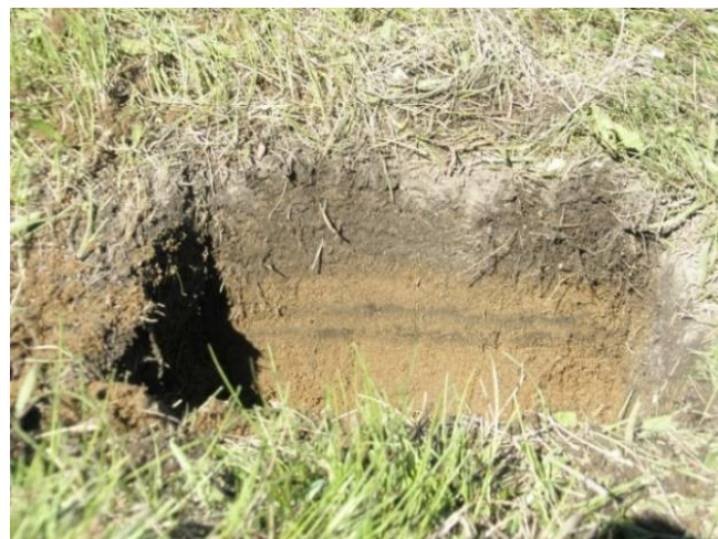
Figur 43. Hovedvei med infiltrasjon og rensing av overvann i filtergrøft, avrenning fra 3 kjørebane til avbildet grøft (kegler satt opp i forbindelse med pågående infiltrasjonsundersøkelse i grøfta). Terskler er ikke synlige på bildet. Forurensninger, slitasjeprodukter og støv fra veien akkumuleres i toppsjiktet i grøfta og vises som mørkfarget toppsjikt i høyre foto. Veien har vært i drift i 15 år, E6 Minnesund. (Foto: COWI).
