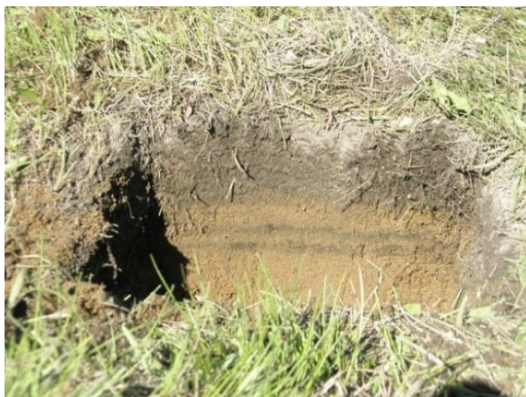
Figur 18. Mørkfarget slamlag i overflaten av bunn filtergrøft langs hovedvei tilført fra trafikken/overvannet i løpet av 15 års drift (E6 Minnesund). Underliggende opprinnelig jordmasse (lysfarget) bestod av middels sand (foto: COWI).
