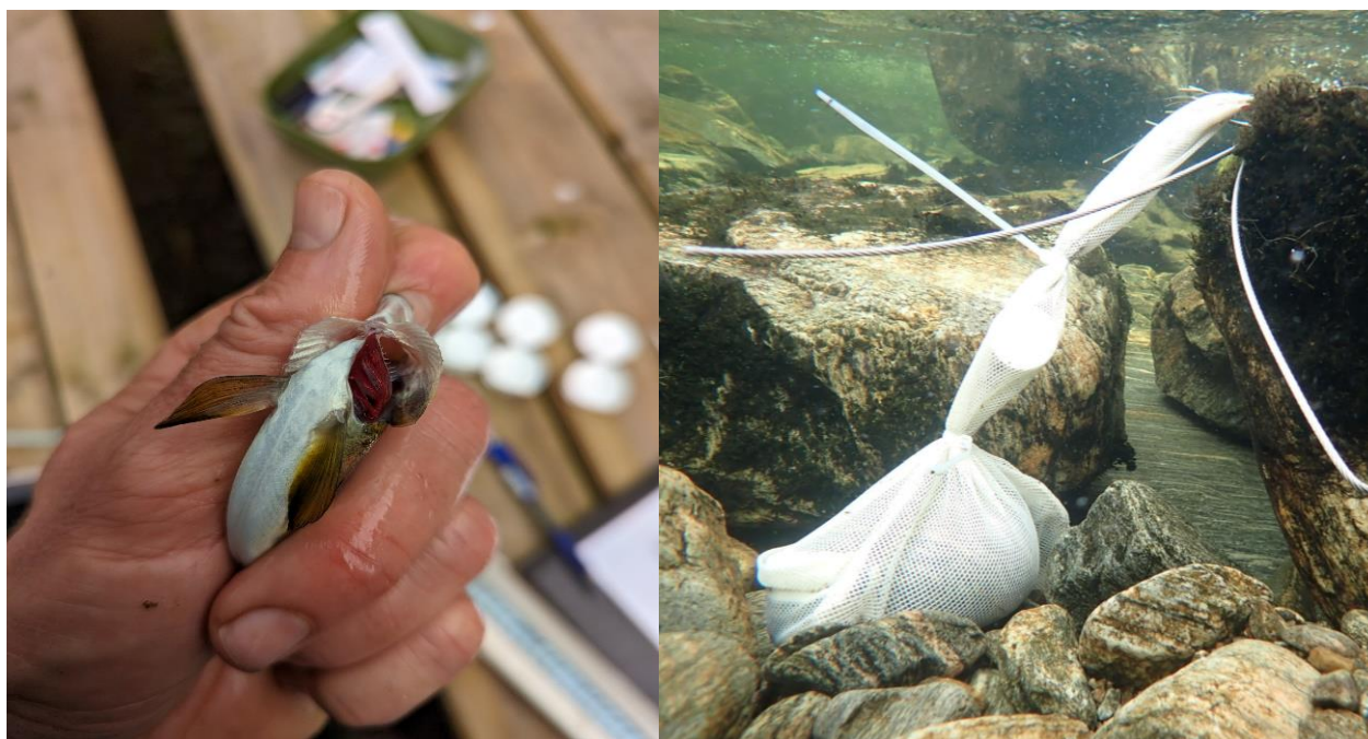
Figur 3. Venstre: Laksesmolt nede i Dirdalselva i 2023, klar for å få dissekert ut en gjellebue. Høyre: Nett med passiv prøvetaker i Ekso i 2024. Prøvetakeren ligger i det øverste «rommet» i nettet, i det nederste «rommet» er det et lodd som sørger for at nettet hele tiden ligger under vann. Nettet er festet i en vaier på land som sørger for at prøvetakeren ikke legger seg ned på bunnen.
