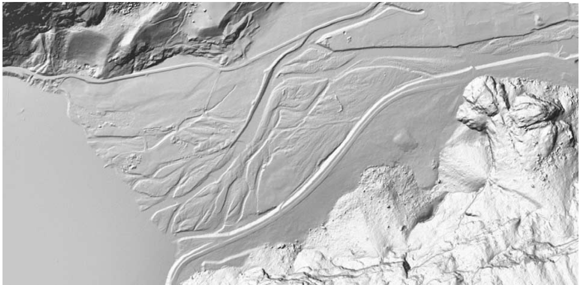
Fig. 6 3D-modell basert på laserscanning som viser gamle elveløp og sideløp i Vassbygdelvas delta. Slike data er bl.a. tilgjengelig fra www.hoydedata.no .
