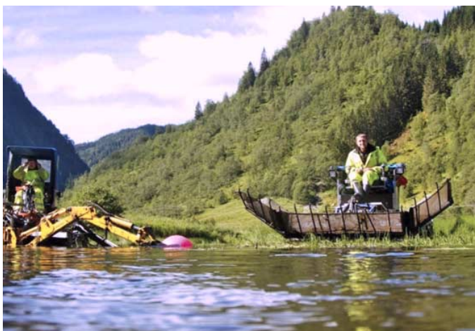
Fig. 65 Fjerning av krypsiv i Teigdalselva (venstre) ved hjelp av gravemaskin og spesialbygd fartøy. Finere sedimenter akkumuleres i og rundt ny tilvekst av krypsiv i Matreelven (høyre).
