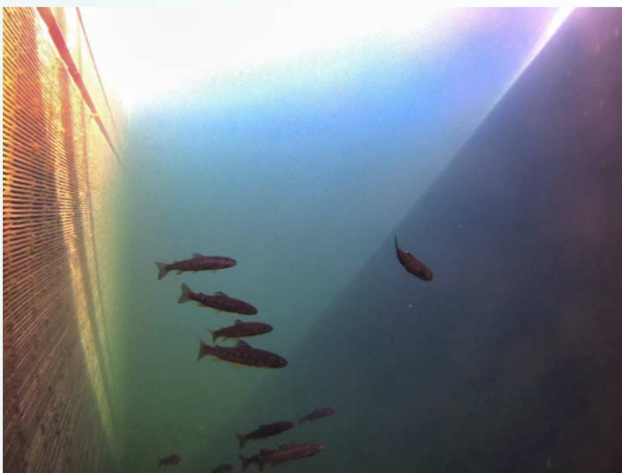
Videostill fra overvåkingen ved beta-rist. Ungfisk følger risten til luke og avleder. (Bilde Voss Energi, Mohntech, NORCE LFI)
