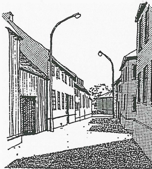
Dagens situasjon. Feil type lysarmatur og stolpe. Lyset har gal høyde
