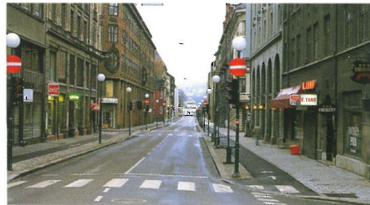
2.11. Tversnitt av Rådhusgaten i Oslo. Den funksjonelle belysningen kommer fra lysarmatur i strekkabel, men «miljøbelysningen» kommer fra de sideplasserte kulelysene. Kilde: Byggekunst nr. 1/1993. Tegn: Selberg Arkitektkontor AS
