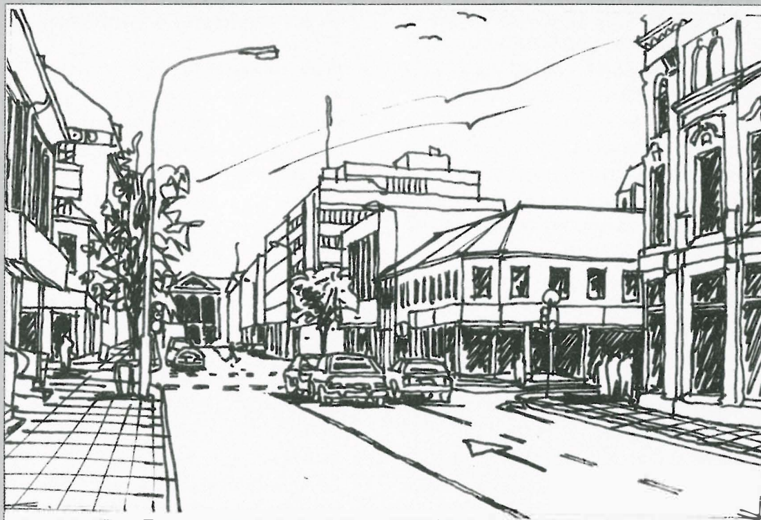
6.2 Olav Tryggvasons gate i Trondheim. Belysning for veglegg utenfor tettbygd strøk skal ikke benyttes som markering av hovedgater. Dette er et eksempel på uheldig valg av stolpe og armatur. Armaturen er av en type som gir uønsket blinding og som bør bli erstattet av typer med mindre blinding. Tegn.: Selberg Arkitektkontor AS
