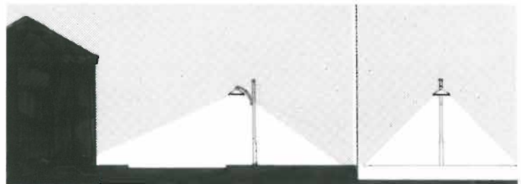
6.40. Med lave master med retningsstyrt lys unngår en problemer med uønsket strølys. Tegn.: Selberg Arkitektkontor AS
