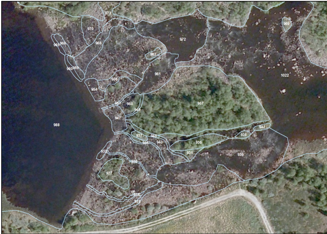
Figur 4. Eksempel på inndeling i klassifiseringsenheter (polygoner) på terskel 3 Fossgård. Terskelen ble inndelt i 22 polygoner med samlet areal 3807 m 2 (gjennomsnitt 173 m 2 ± SD 296,0).
