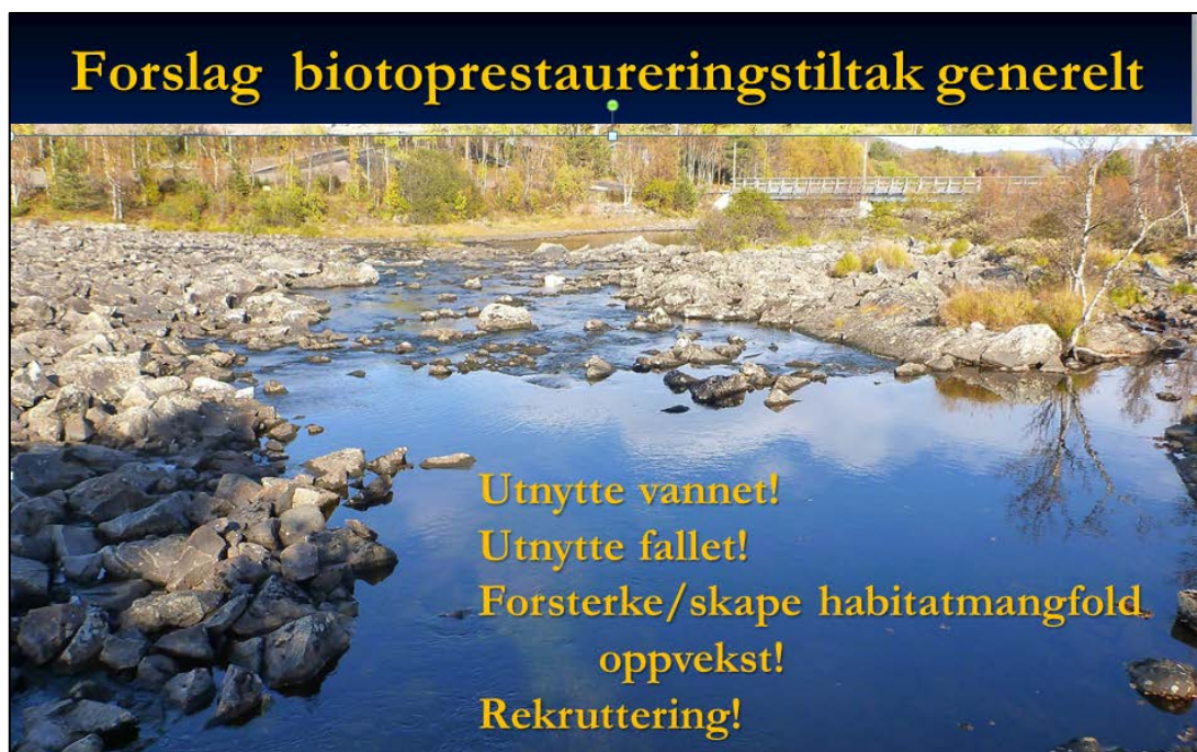
Fig. 25. Grov løsmasseterskel hvor vannet forsvinner til venstre, naturlig elv med varierende habitat til høyre, samt generelle forslag til biotope tiltak for alle løsmassetersklene (fra semi-naturlig løp i sør i terskel 5 Lauverud).
