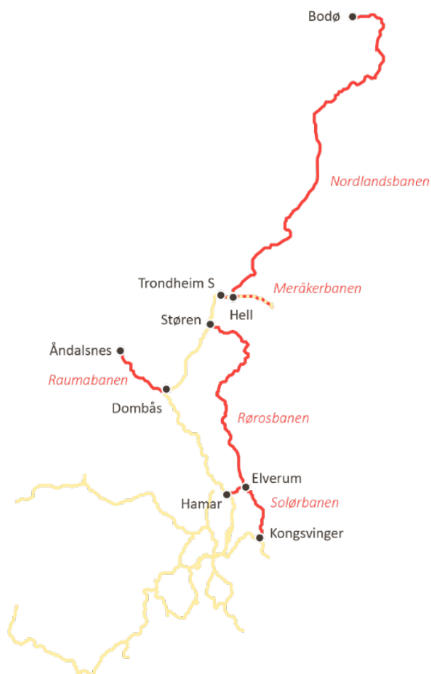
Figur 3: Omriss av det norske jernbaneliknet (ekskludert Ofotbanen) som er i drift. Gule strekninger er elektrifisert, stiplete strekninger er under elektrifisering, og røde strekninger er ikke elektrifisert.
