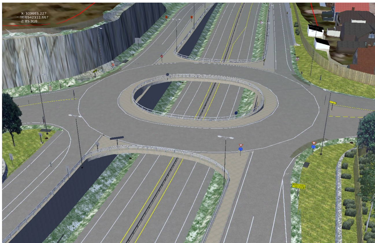
Figur 3.2.5—1 — Eksempel på brurekkverk ved rundkjøring.
