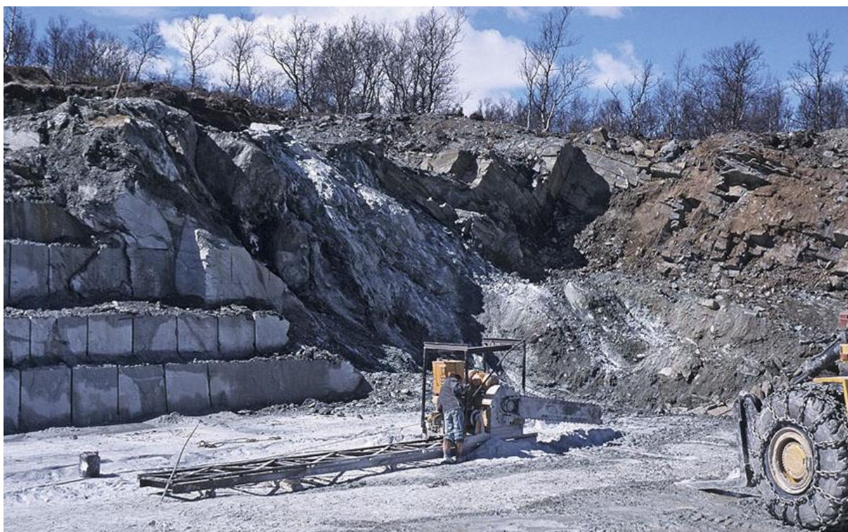
SVERIGE: Klebersteinsbruddet ved Handöl i Jämtland er i full drift. Kjedesaging av blokk. Foto: Per Storemyr
