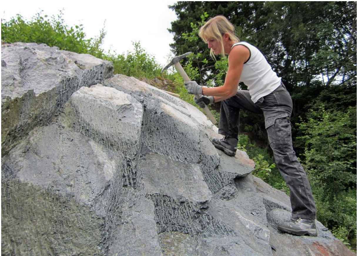
STAVSØIENS EKSPERIMENT: Eva Stavsøien tar ut kleber med gammeldags kanalhogging i kleberbruddet på Klungen i 2011. Foto: Per Storemyr
