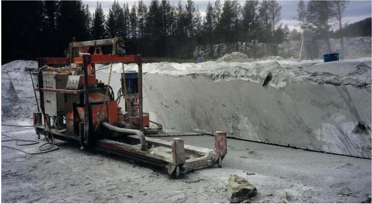
KJEDESAGING: Moderne kjedesaging i Nyseterbruddet ved Otta i 1998. Foto: Per Storemyr
