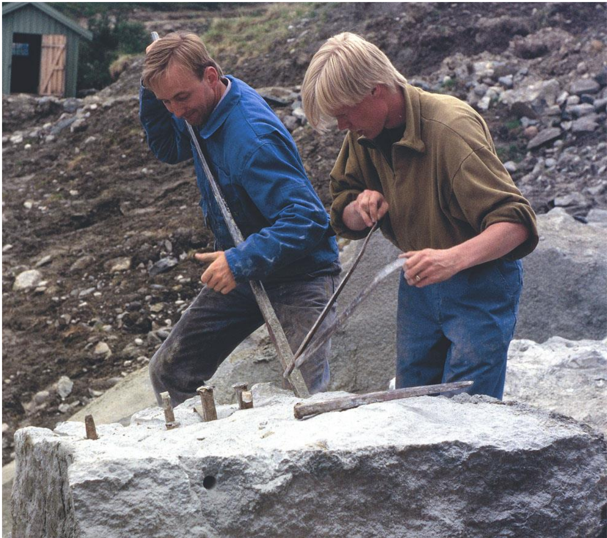
SPLITTING: Steinhoggerne Atle Elverum og Henning Grøtt deler opp blokk ved hjelp av kiler med blekker i kleberbruddet på Bubakk ved Kvikne i 1995. Dette var et av de aller siste steinuttakene i bruddet. Nå forvitrer steinen de tok ut... Foto: Per Storemyr
