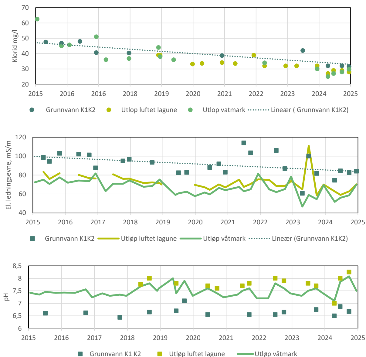
Figur 5: Klorid, ledningsevne og pH målt i grunnvannsbrønner (K1 og K2), utløp luftet lagune (LLut) og utløp våtmark (VM3).
