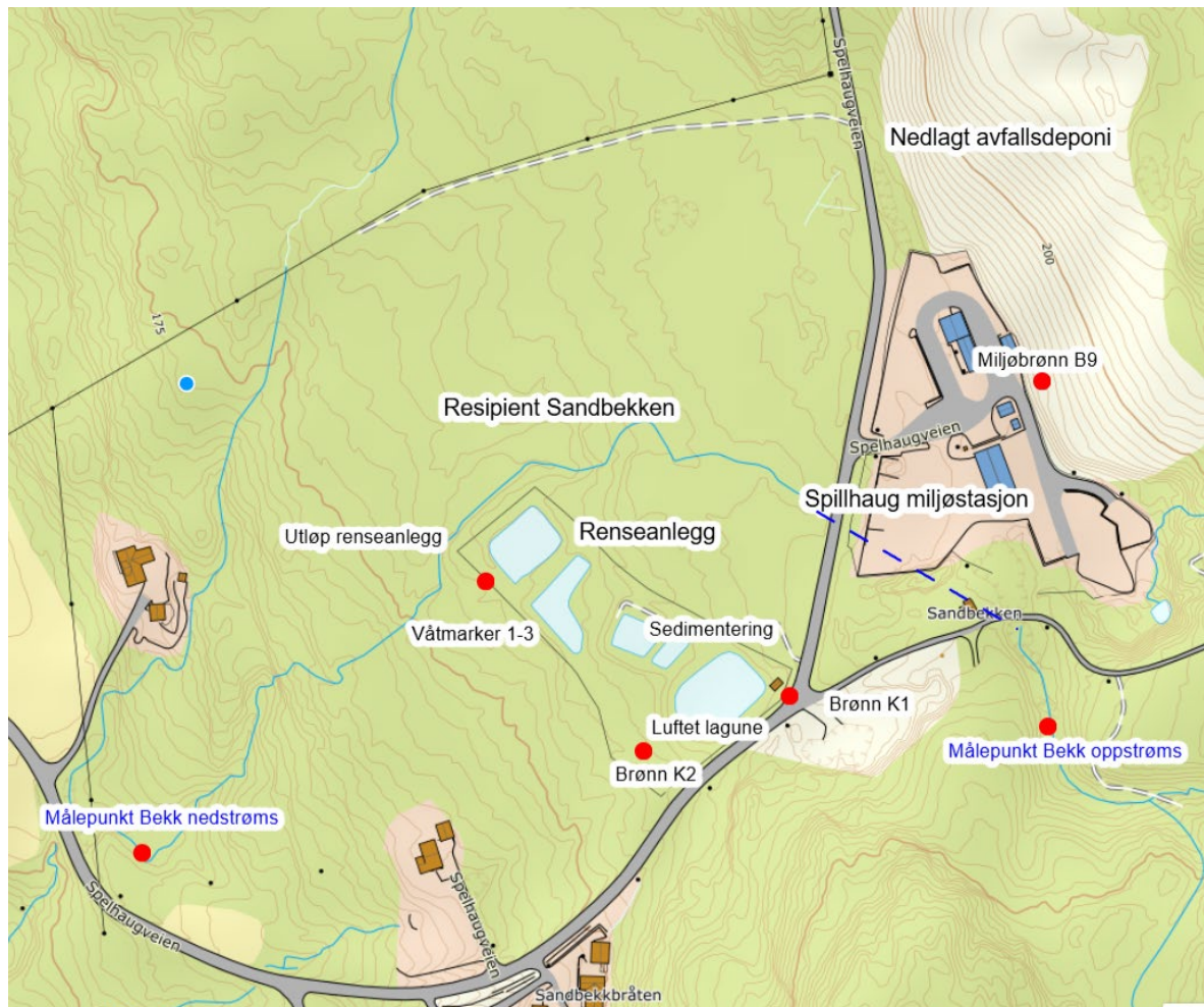
Figur 1: Kart over deponiområdet med renseanlegg, pumpebrønner (K1 og K2) og resipient Sandbekken. Et flyfoto over området er vist på side 31. Sigevannet når grunnvannet i en sandig akvifer som strømmer i retning pumpebrønner K1 og K2. Grunnvannsmagasinet med sandige løsmasser er avgrenset av relativt tette fjellmasser av gneis og granitt.
