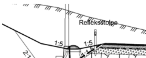
Figur 40. Prinsipp for sidegrøft. Areal med helning 1:5 foreslås asfaltert.
