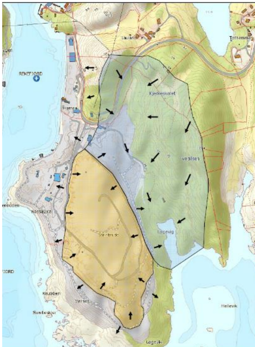
Figur 29. Overflateavrenningskart etter dagens terrenggradienter (NGU, 2016).
