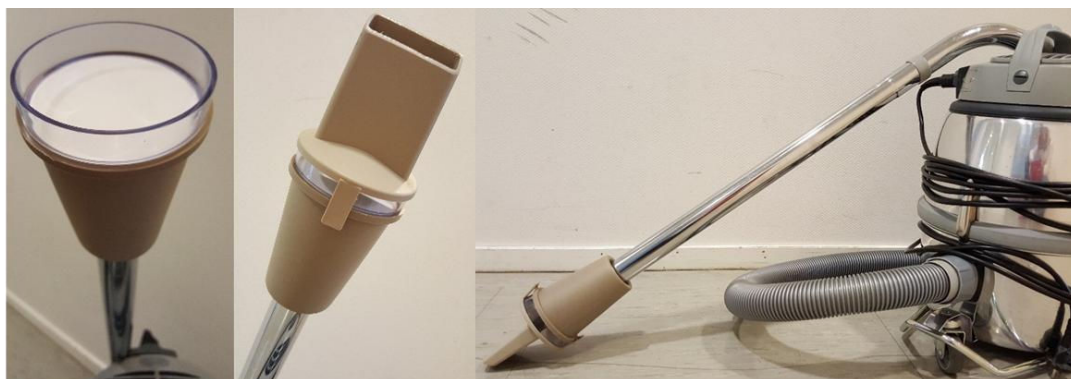
Figur 1: Montering av adapter og filterholder på støvsuger.
