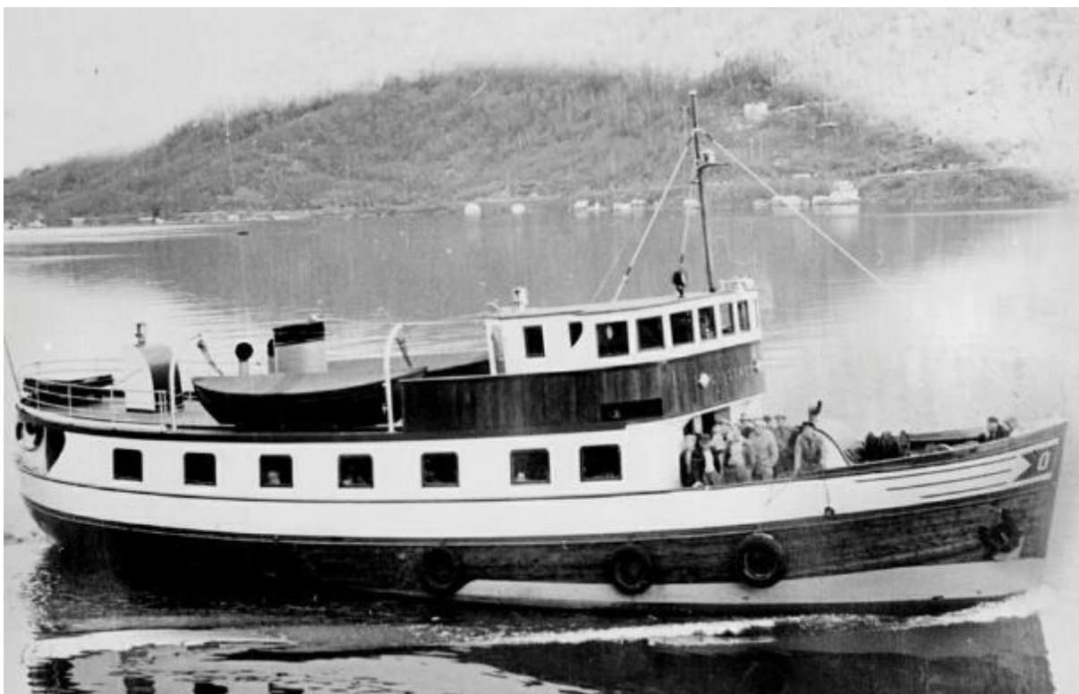
figur 7: LLBU "Lindenes" etter 1950. Styrhuset er flyttet fram og store deler av dekket er overbygget. Båtdekket er dermed også større.
