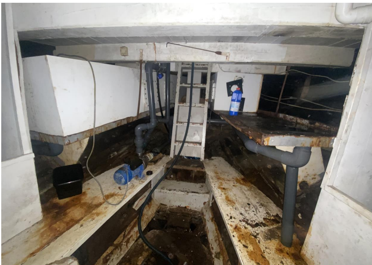
figur 63: Akterlugaren sett akterover, 2021. Leideren og nedgangen har sannsynligvis kommet til med ombyggingen i 1950.
