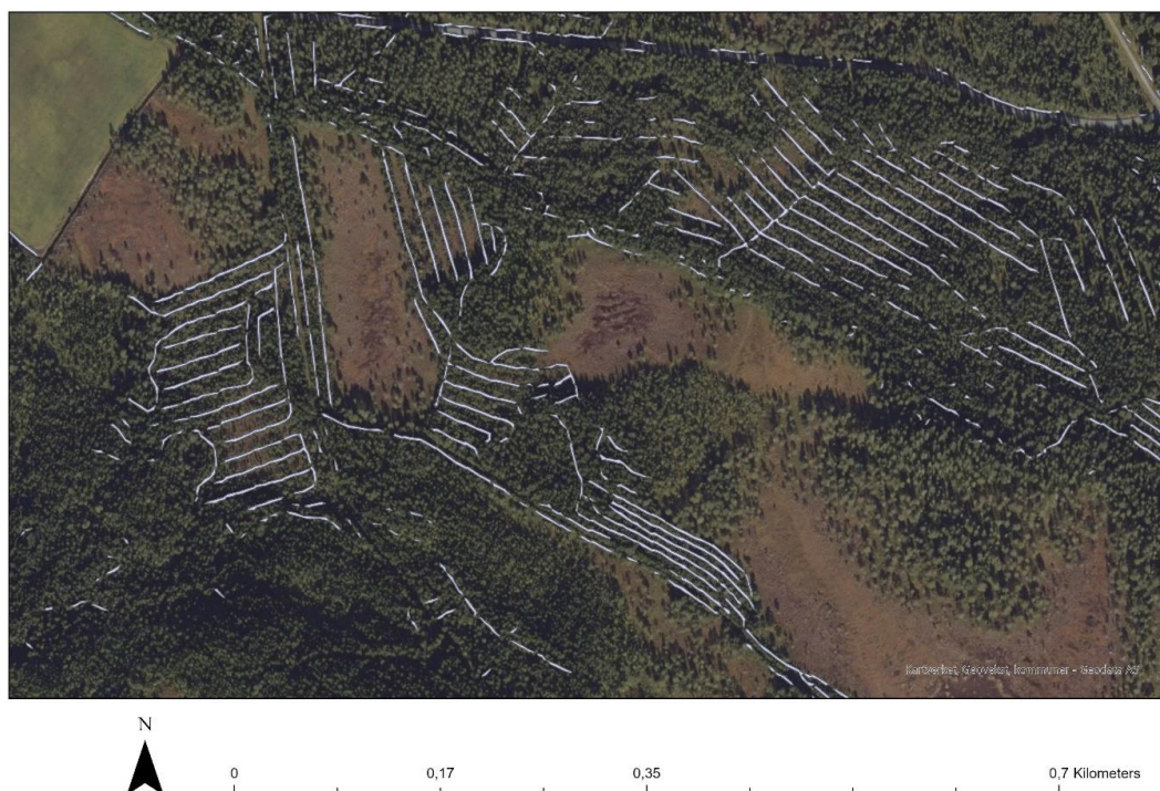
Figur 6. Figuren viser hvordan rasteret fra Figur 4 ser ut etter at det ble konvertert til polygoner. Denne prosedyren gjør det mulig å representere grøftene som distinkte geometriske figurer. Små polygoner på mindre enn 5 kvadratmeter er fjernet.
