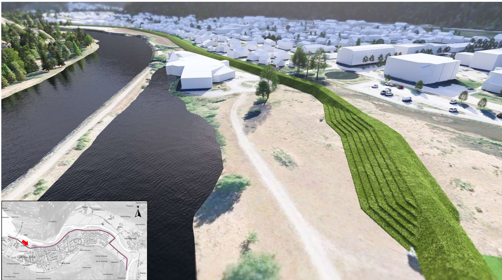
Figur 2-8: 3D-illustrasjon av planlagte flombarrierer, grøfter og pumpestasjoner i tiltakskombinasjon 2A ved Lærdal kultursenter sett fra vest.
