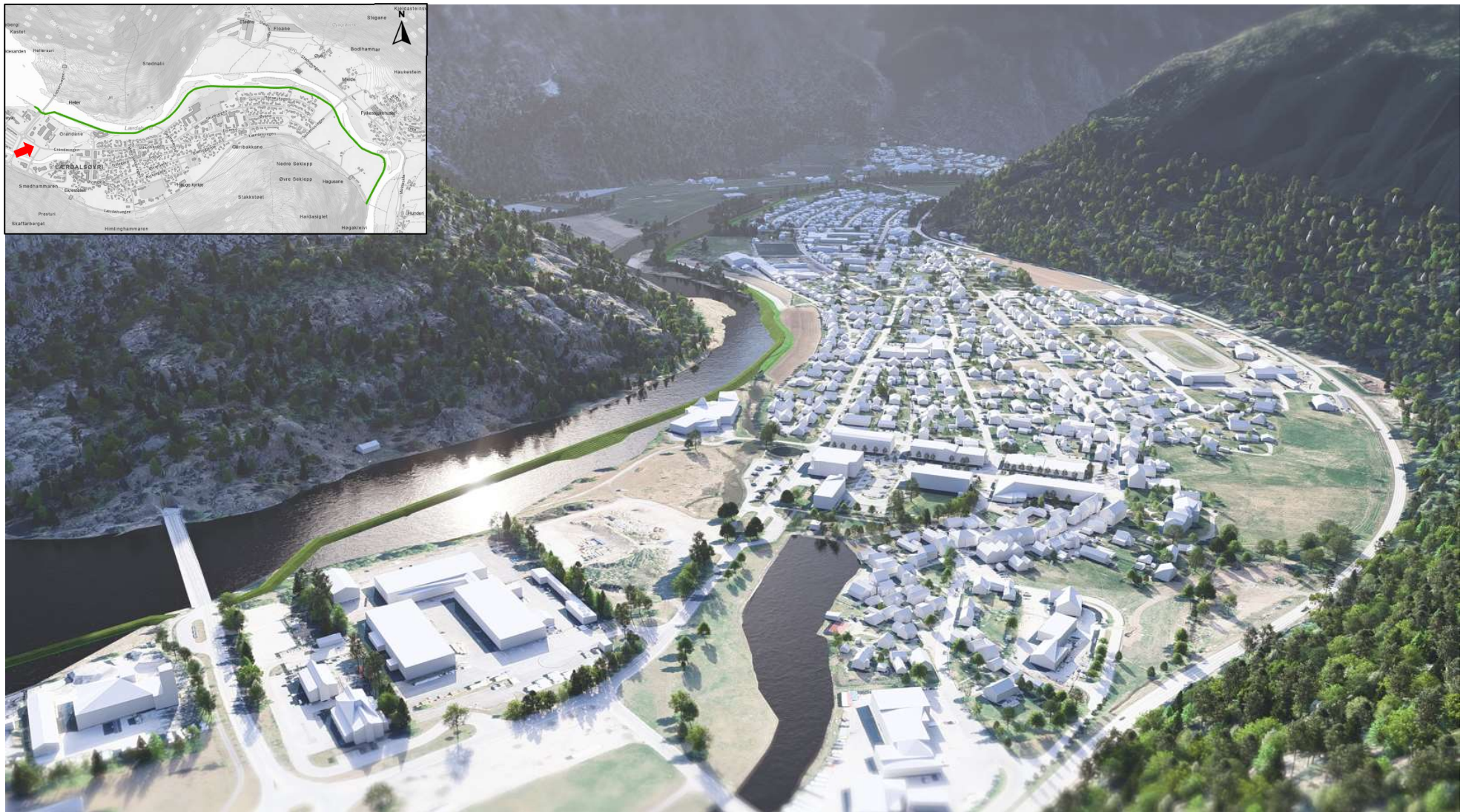
Figur 3-7: 3D-illustrasjon av planlagte flombarrierer, grøfter og pumpestasjoner i tiltakskombinasjon 2B sett fra sørvest.
