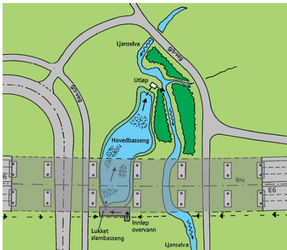
Figur 11: Rensedam ved E6 Skullerud i Oslo med helstøpt og lukket sedimentasjonskammer og vanddyp 1,5 m (Fra Åstebøl og Coward 2005).
