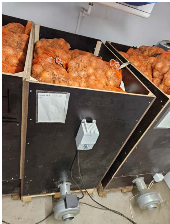
Figur 1. Tørkekasse brukt i lagerforsøk, plassert i forsøkslagercelle med styrt temperatur og luftfuktighet. Vifte og netting i bunn av kasse. Luften presses opp gjennom løksekkene.
