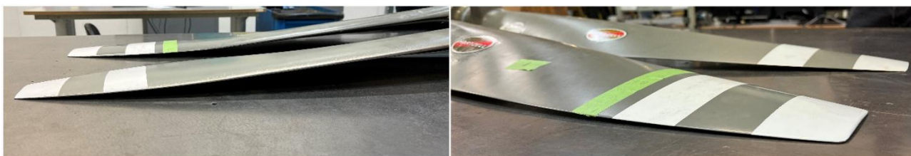
Figur 15: Propellblad nr. 1 fra LN-TBN (merket med grønn tape) lagt ved siden av et tilsvarende propellblad viser at ytterste del av bladet er bøyd forover. Foto: SHK
