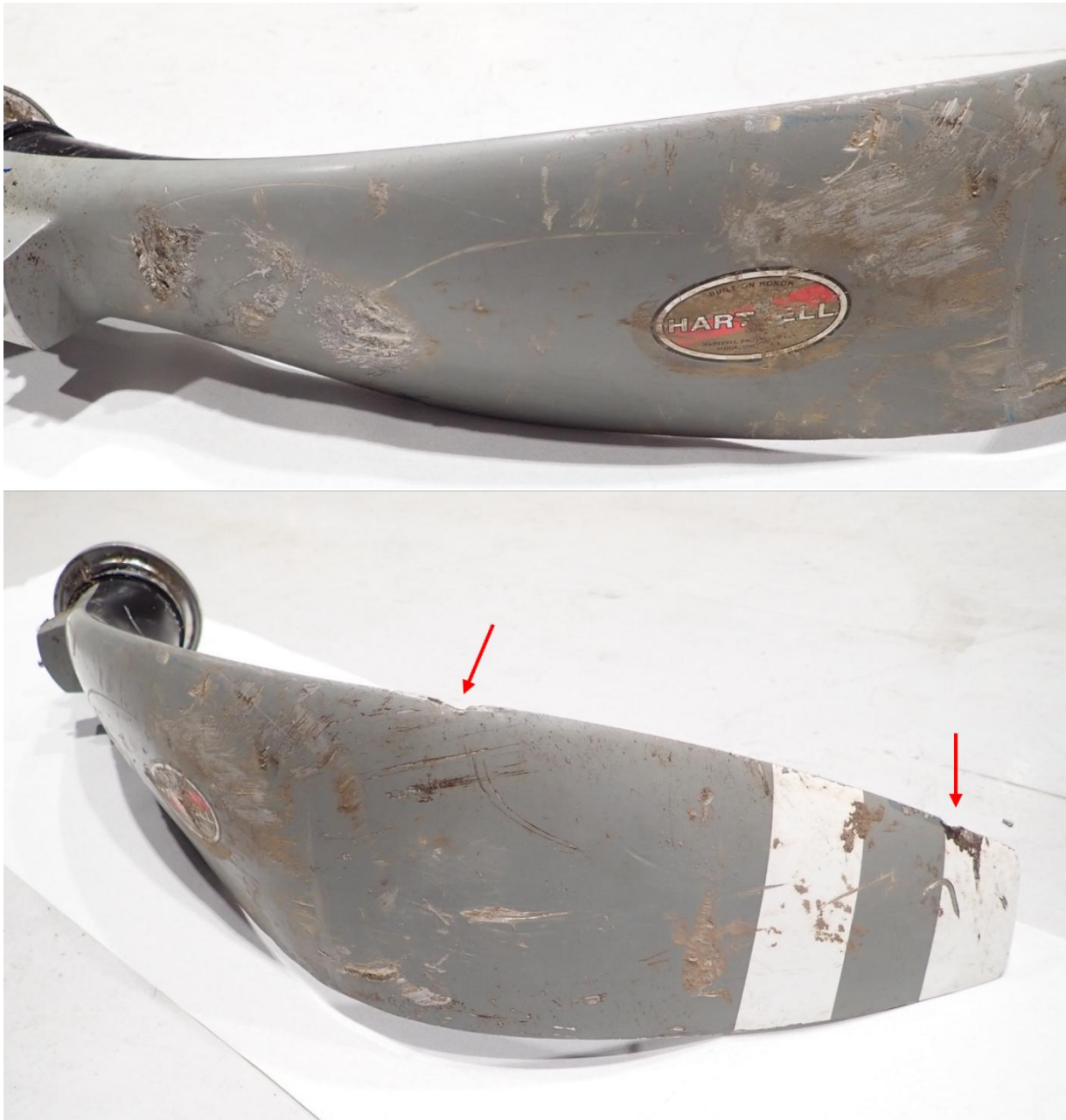
Figur 16: Propellblad nr. 2 fra LN-TBN. Røde piler indikerer to markante kutt i bladets leading edge. Foto: SHK
