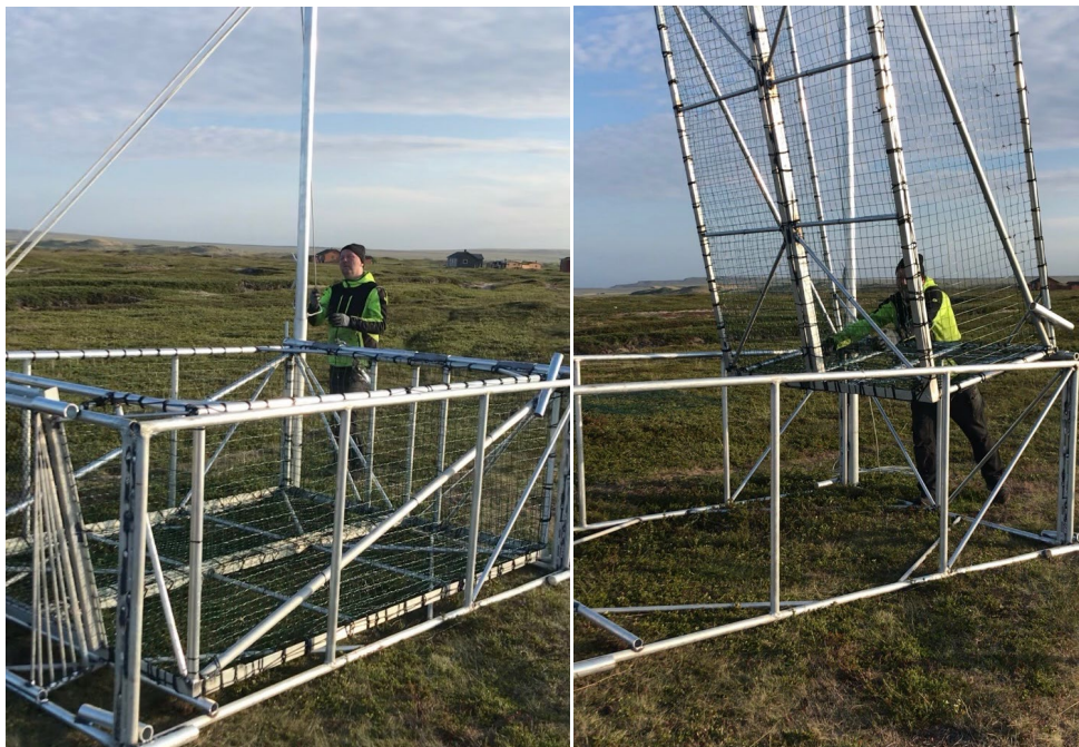
Bilde 4. Bildet til venstre viser fangstburet i nedsenket posisjon. For å røkte fella ble fangstburet løftet opp med et tau via et trinsesystem og en stang (høyre bilde). Foto: Kjell Odin Larsen
