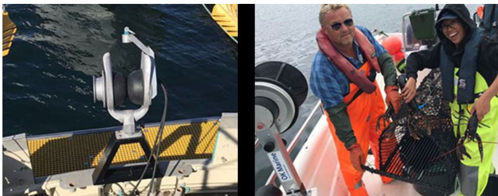
Figur 24 Hauler brukt i Havforskningsinstituttet sitt ryddetokt etter tapte redskaper i Raet nasjonalpark i 2020. (Rapphydema 500kg hydraulisk haler (venstre) og 24 V Profisher 220kg elektrisk haler (høyre)) (Kleiven et al., 2021).
