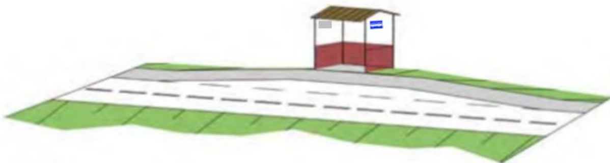
Figur 3.4—4 — Plassering av bussholdeplasskilt på leskur anbefales når leskur finnes. (Skiltet bør plasseres øverst til venstre på endevegg rettet mot kjøreretning, og øverst til høyre på motsatt endevegg, eventuelt oppe på taket).
