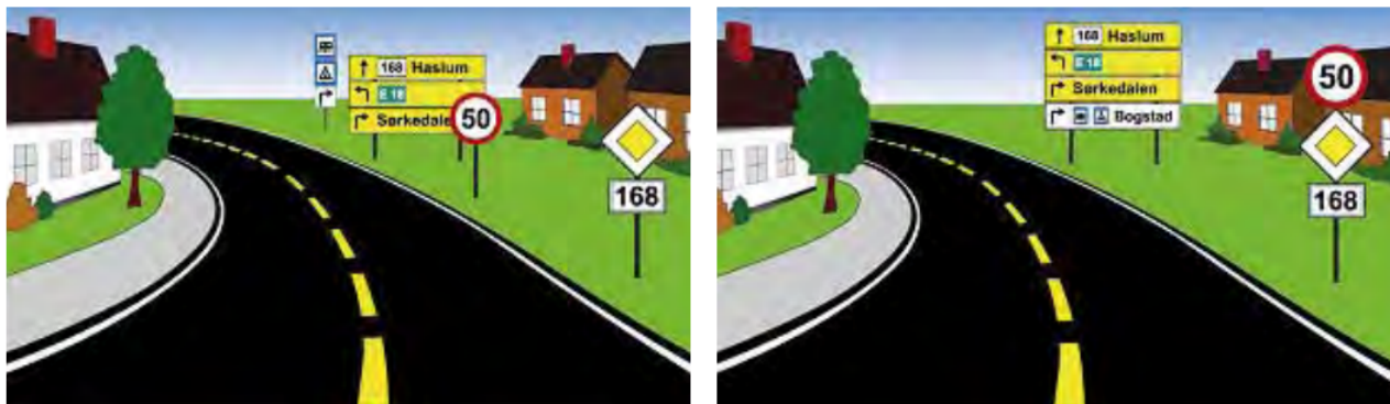
Figur 3.9—1 — Avstanden mellom trafikkskilt bør være minst 50 m.
