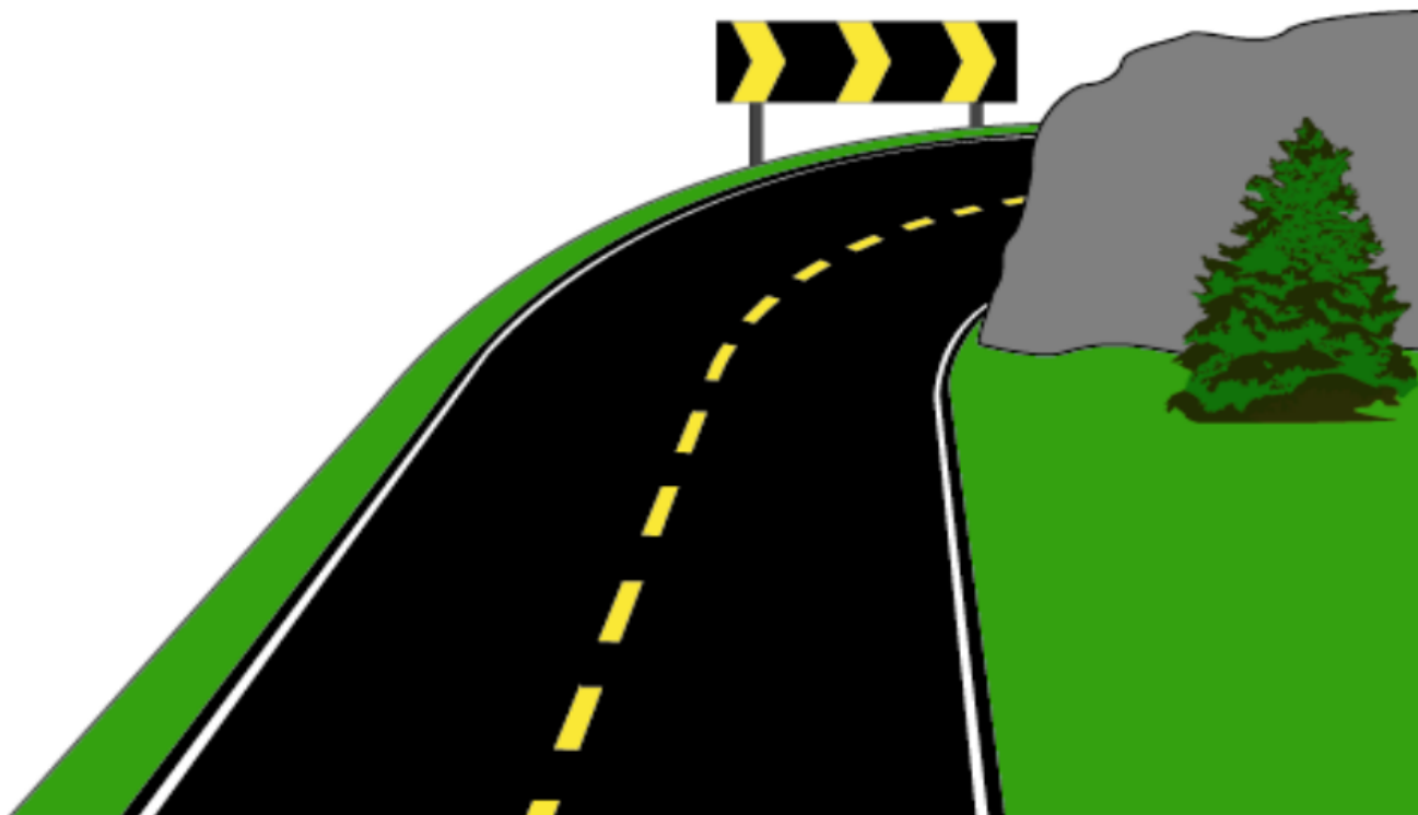
Figur 3.1.1—4 — Eksempel på bruk av bakgrunnsmarkering i kurve med dårlig sikt
