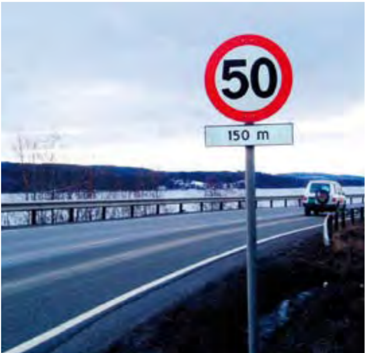
Figur 3.3.7—5 — Eksempel på forvarsling av nedsatt fartsgrense
