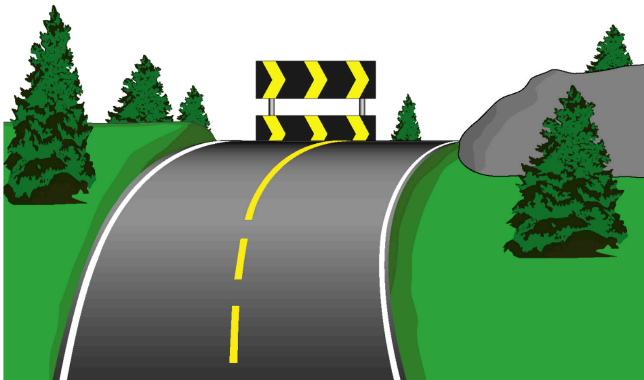
Figur 3.1.1—6 — Eksempel på bruk av bakgrunnsmarkeringer i kurve skjult bak høybrekk
