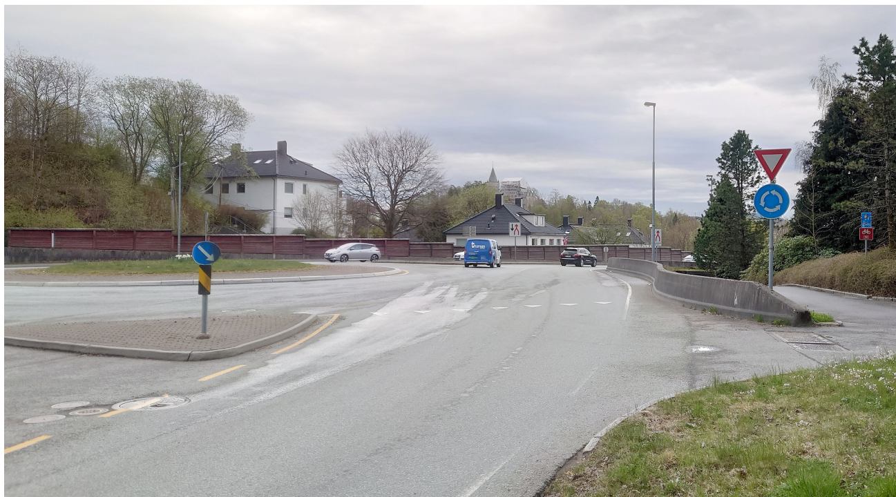
Figur 3.2—4 — Eksempel på vikepliktskilting på høyre side av vegen
