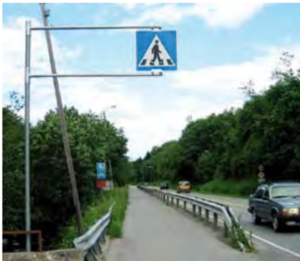
Figur 3.4—8 — Eksempler på utkraging av gangfeltskilt for å få skiltet synlig nok
