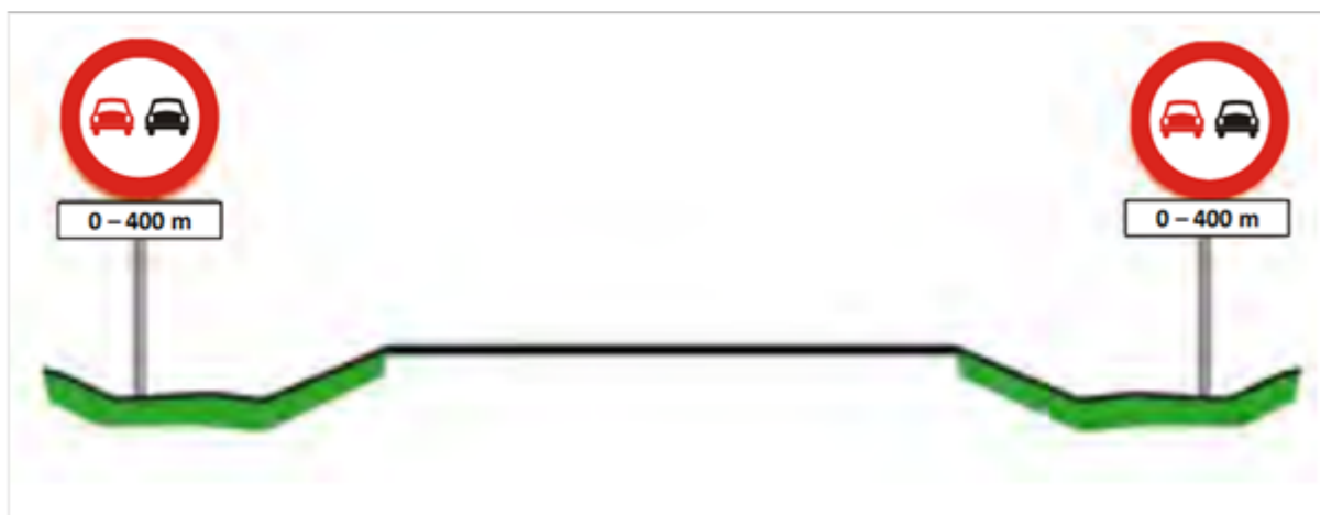
Figur 3.3.6—2 — Forbikjøringsforbud med utstrekning
