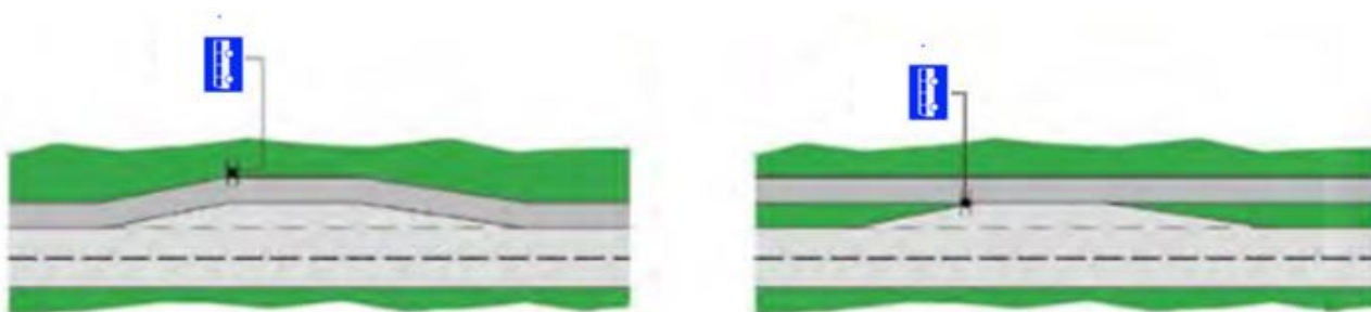
Figur 3.4—5 — Plassering av bussholdeplasskilt i busslomme (plasseres der bussen normalt har inngangsdør)
