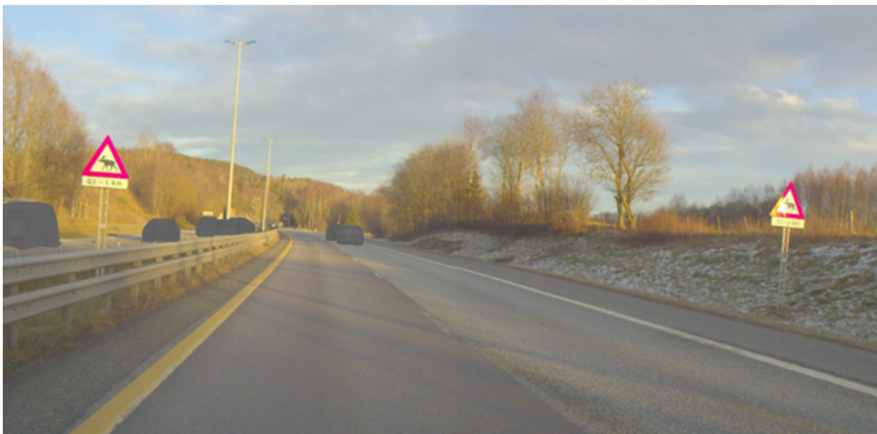
Figur 3.1—2 — Eksempel på oppsetting av fareskilt på begge sider av veflerfeltsveg, med underskilt 804 som angir utstrekning av faren.
