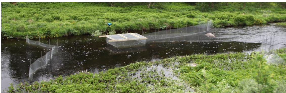
Oppvandringsfelle i drift. Pilene i bildet markerer løse nettinggjerdet som er satt opp for å fange planterester. Nettingen kan enkelt løftes på land, og ristes rene.
