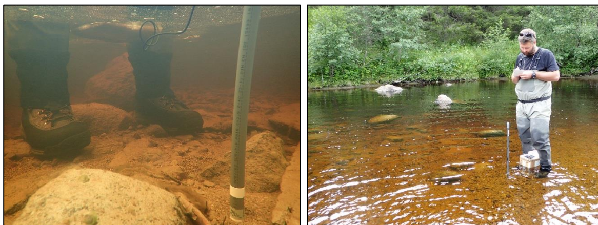
Figur 3. Måling av redokspotensial i substratet. Foto: Bjørn Mejdell Larsen.
