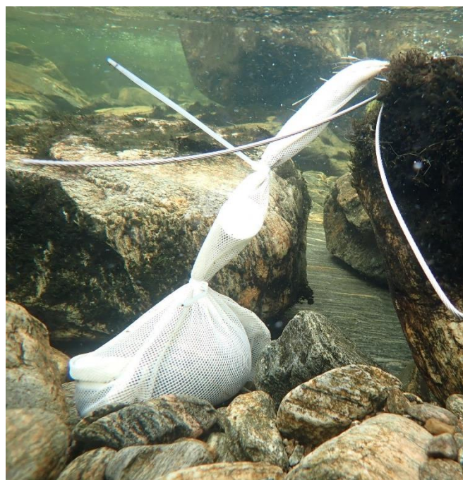
Figur 3. Venstre: Laksesmolt nede i Daleelva i 2024, klar for å få dissekert ut en gjellebue. Høyre: Nett med passiv prøvetaker i Ekso i 2024. Prøvetakeren ligger i det øverste «rommet» i nettet, i det nederste «rommet» er det et lodd som sørger for at nettet hele tiden ligger under vann. Nettet er festet i en vaier på land som sørger for at prøvetakeren ikke legger seg ned på bunnen.
