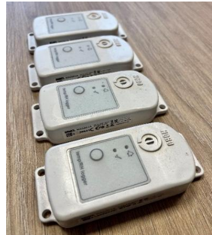
Figur 15: HOBO-loggere for måling av temperatur og luftfuktighet.
