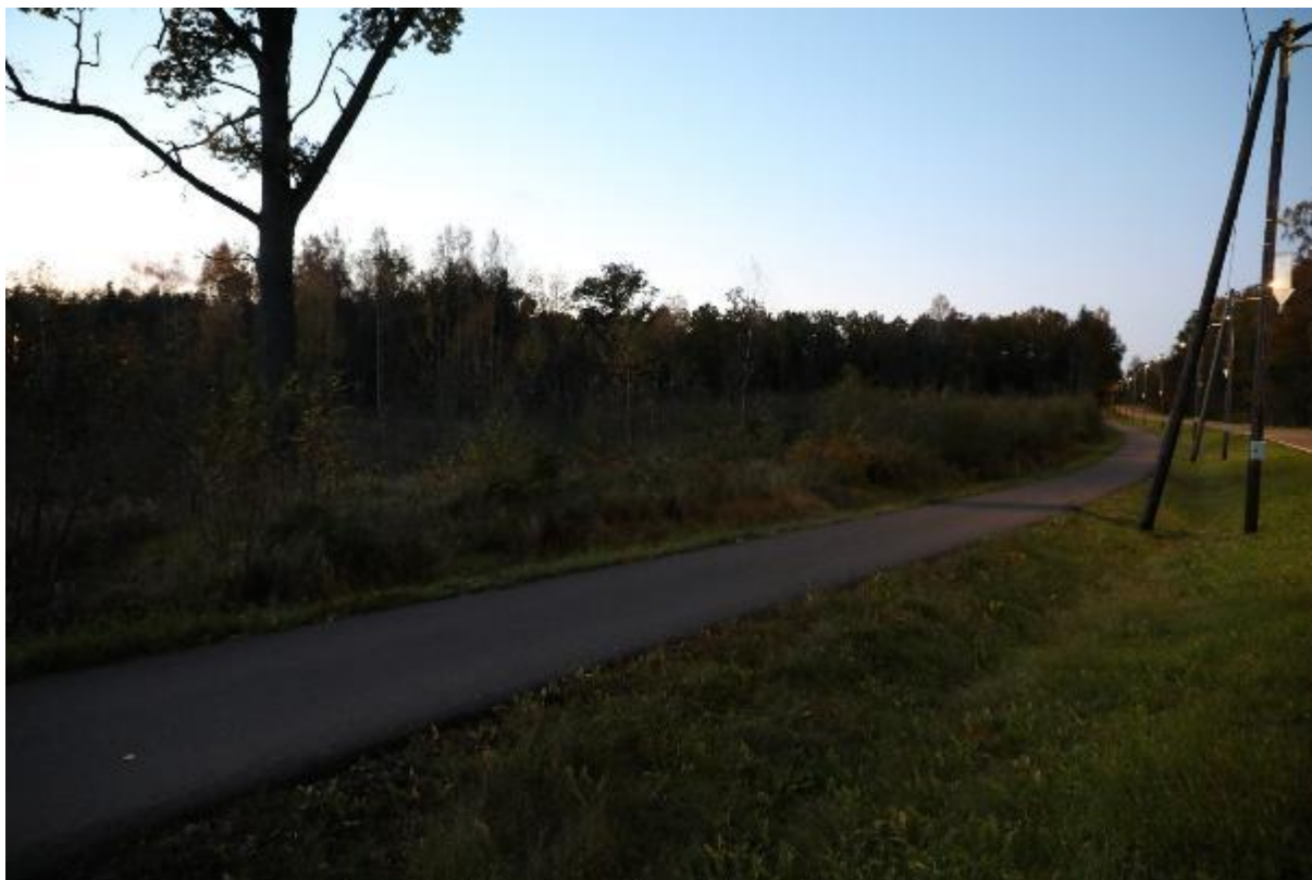
Figur 45: Foto av forsøksområde I med lysmaster plassert mellom gang- og sykkelvei (på Figur 1 angitt som gangsti) og veibane. Lysmålinger og forsøk er utført på gang- sykkelvei, vei og i et transekt som strekker seg fra lysmastene og ut i terrenget til venstre på bildet.
