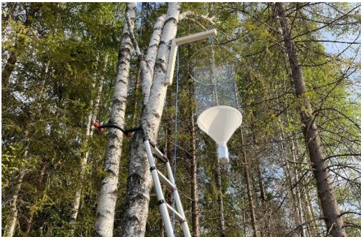
Figur 8: En av vindusfellene som ble brukt til insektinnsamlingen. Fellene som ble plassert 60-100 meter fra lysmastene ble montert i trær. Foto: Ulrike Bayr
