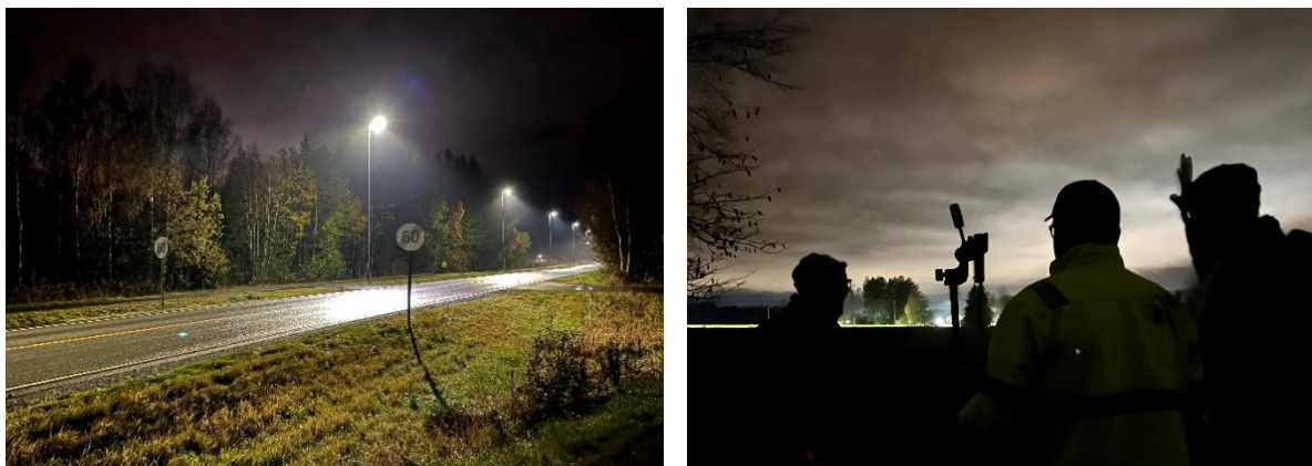
Figur 1: Veilys belyser ikke bare selve veien, men kan også spres til omkringliggende områder, enten direkte på grunn av manglende avskjerming eller indirekte via refleksjon fra veibanen (venstre) eller skyer (til høyre). Foto: Ulrike Bayr
