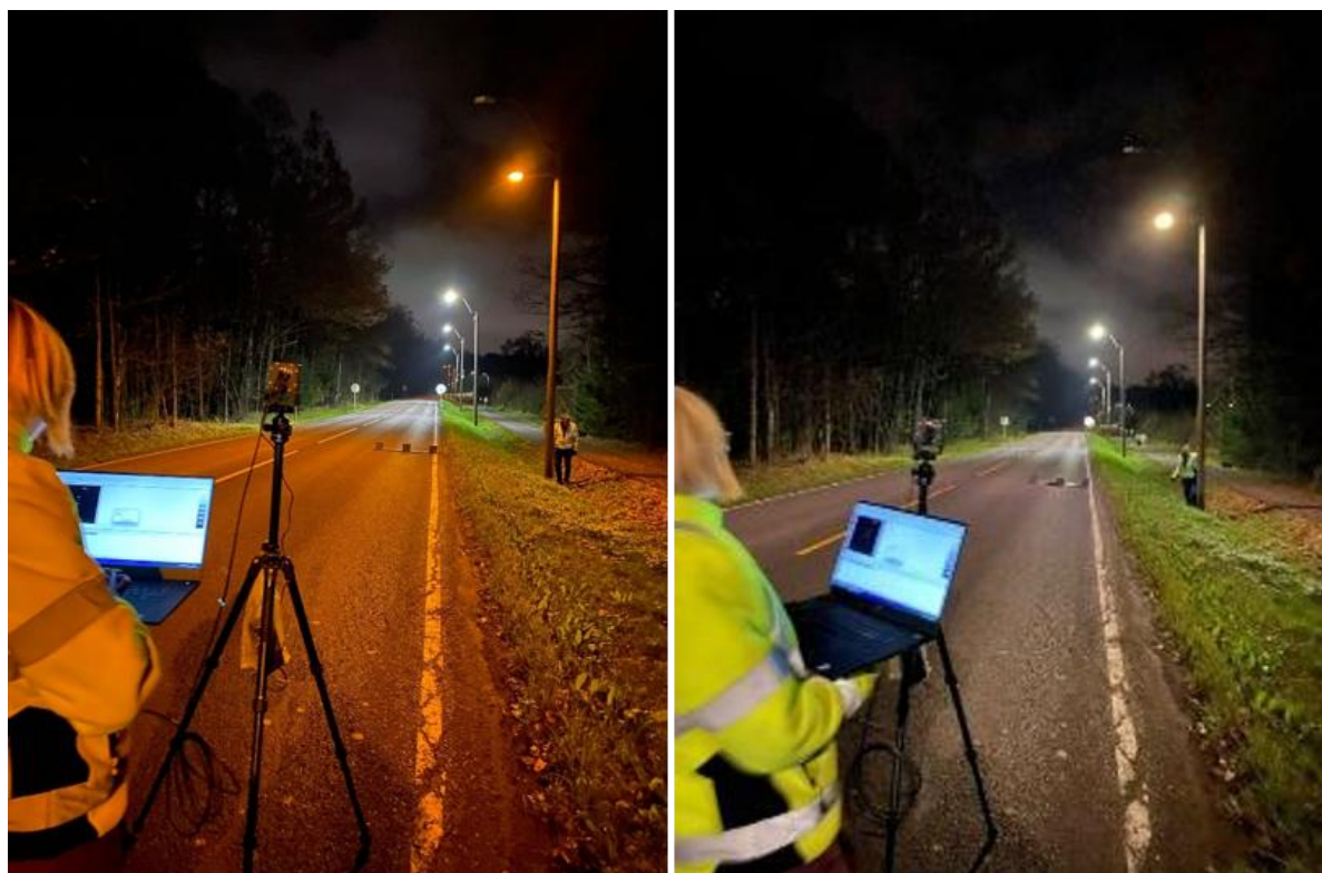
Figur 73: Luminansmålinger av veibanen og de kritiske objektene ble utført med et LMK-luminanskamera under begge lysinnstillingene.
