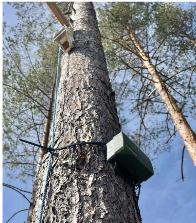
Figur 17: Plassering av en flaggermus-detektor ved en av fellene i det mørke feltet.
