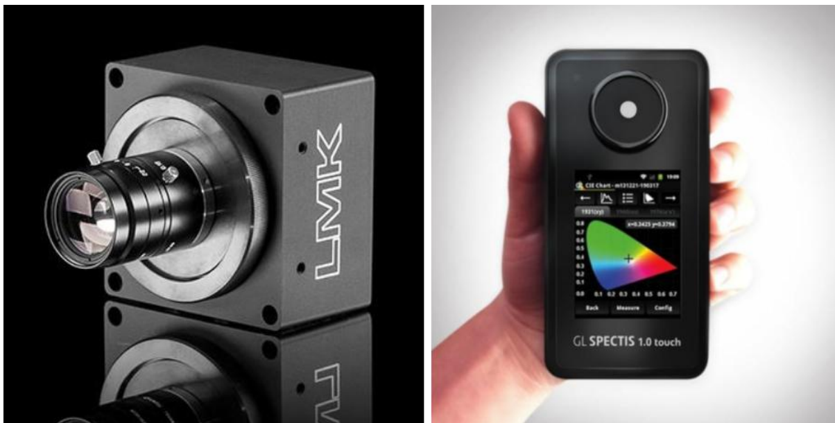
Figur 49: Utstyr til lysmåling. Til venstre: Luminanskamera LMK 6, Technoteam. Til høyre: Spektorradiometer: GL Optics Spectis 1.0
