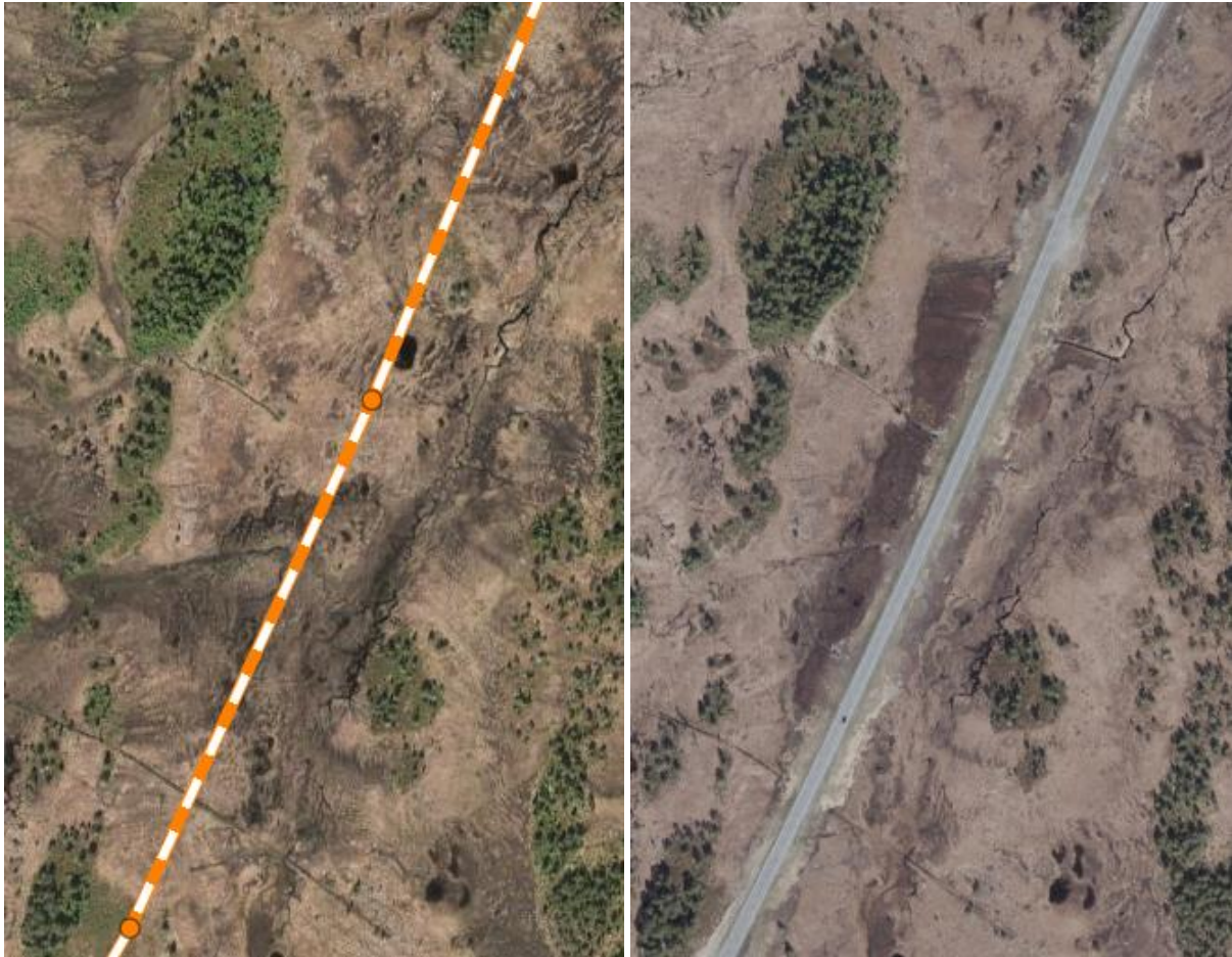
Figur 6. E39 over Høgkjølen. Ortofoto fra 2013 (t.v.) før vegutbygginga. Hvit/oransje markerer dagens veitrasé. Ortofoto fra 2018 (t.h.), etter ferdigstilt vegutbygging. Mørkebrune områder langs veitraséen viser tydelig de utplanerte myrmassene fra vegutbygginga. Flybilder: Norgebilder.no
