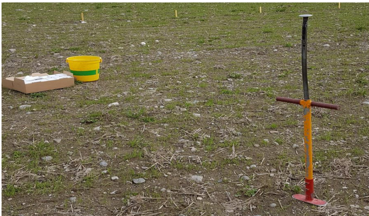
Figur 7. Jordprøvetaking i en kantrute på Apelsvoll. Hver prøve besto av 5–6 prøvestikk. (Foto: Kristian Rindal, NIBIO)
