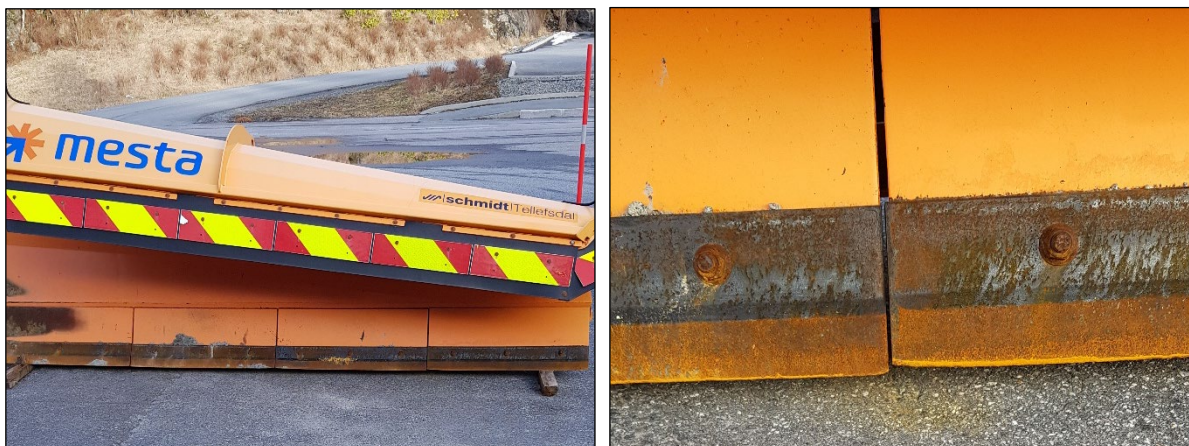
Figur 15-3: Brøyteskjær av stål observert på Haukås ved E39 i Sveio. Skjærene kan ha ujevne seksjoner ned mot underlaget. Nedre kant, og sprang mellom seksjonene, sliter i stykker vegoppmerkingen (Lars Nybø, 2023).
