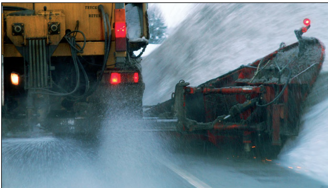
Figur 8-5: Vinterdrift påfører tradisjonell vegoppmerking store slitasjeskader, og en stor del av oppmerkingen hølves vekk (Statens vegvesen, 2010, s. 11).
