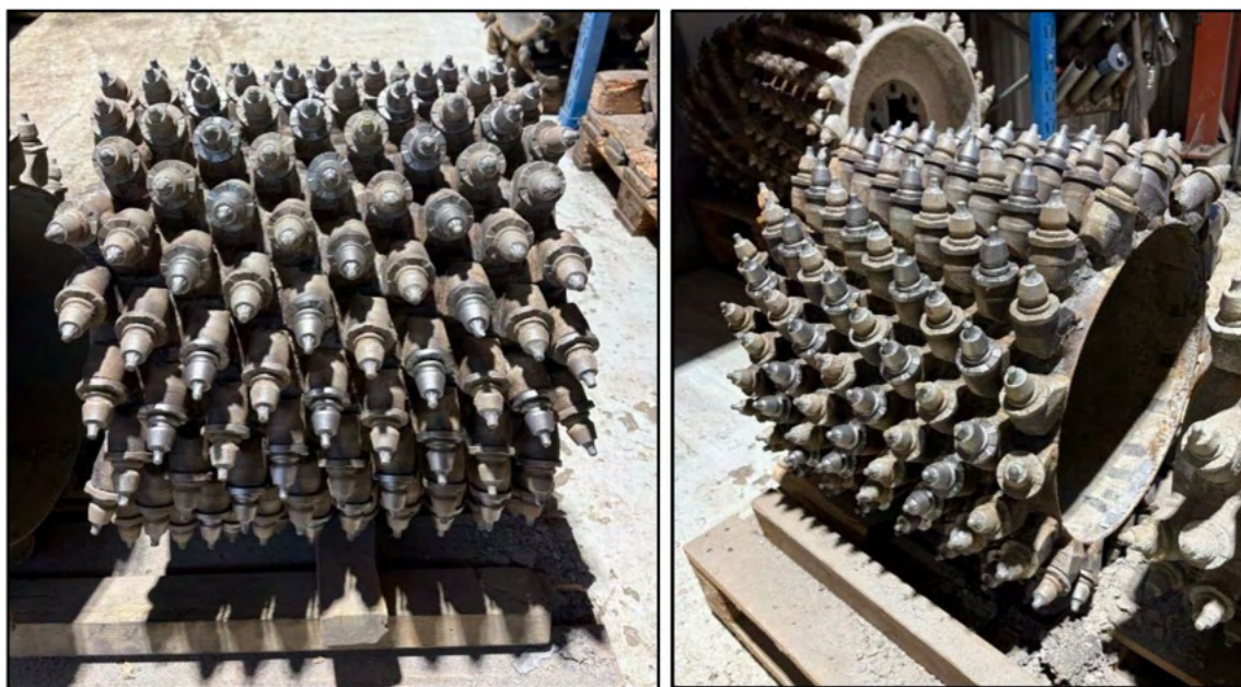
Figur 9-3: Fresetrommel med 3 millimeter tannavstand fremme i bildet. Når man ser hele trommelen under ett, så treffer altså én tann ned på asfalten hver tredje millimeter (Richard Skjæret, u. d.).
