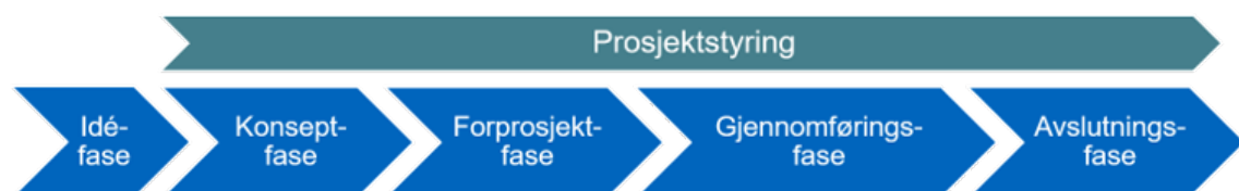
Figur 2.1 Oversikt over de ulike prosjektfasene i PRINSIX-prosjektmodell som benyttes av forsvarssektoren (Forsvarsmateriell, u.å.-b).
