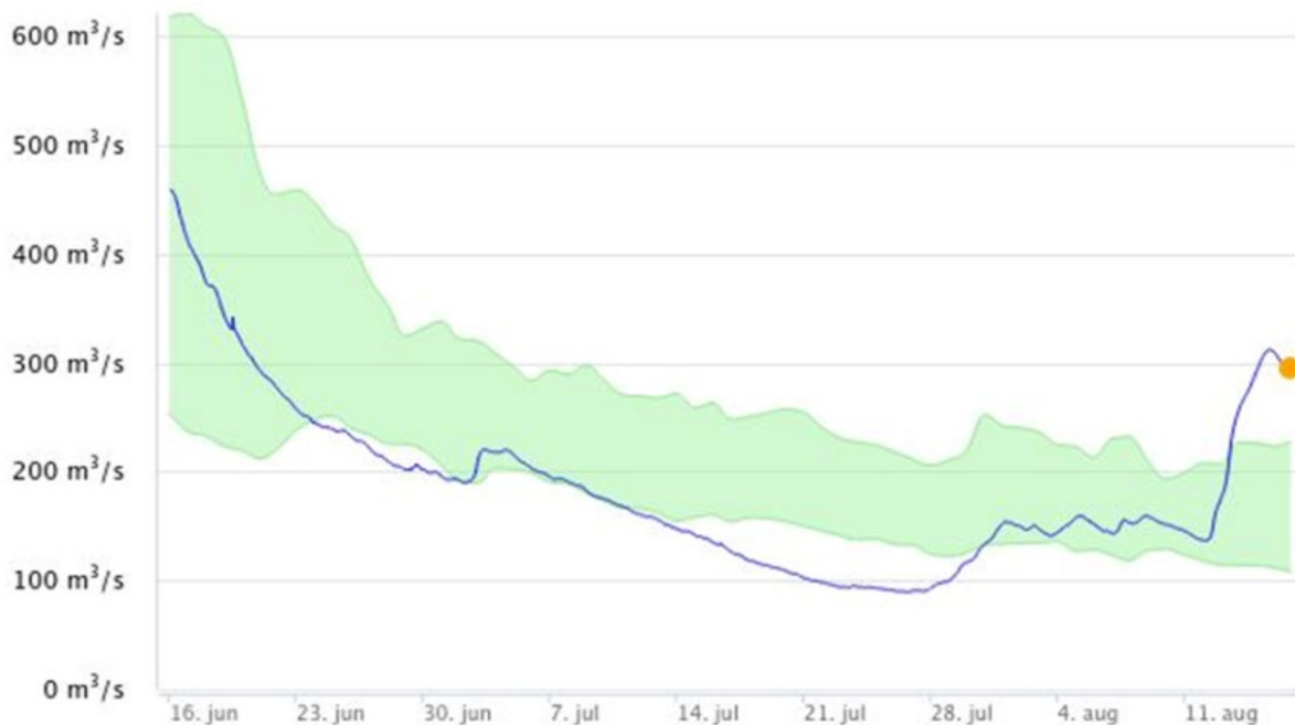
Figur 7.7. Vannføring ved Polmak 16. juni til 16. august. Det grønne feltet i figuren viser vannføringer mellom 25 og 75 percentilen. Data hentet fra Sildre, NVE.
