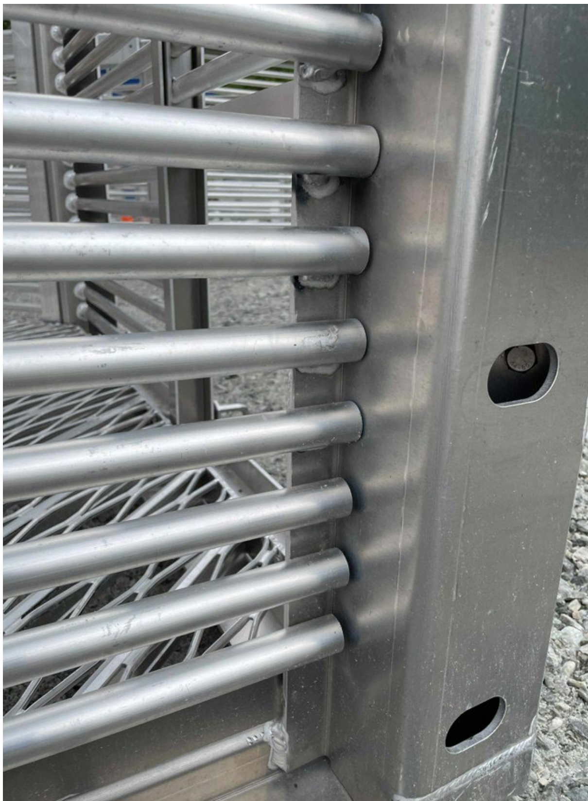
Figur 8.6. Dårlig sveis på spiler i fangstbur. Foto: Reisa Elvelag
