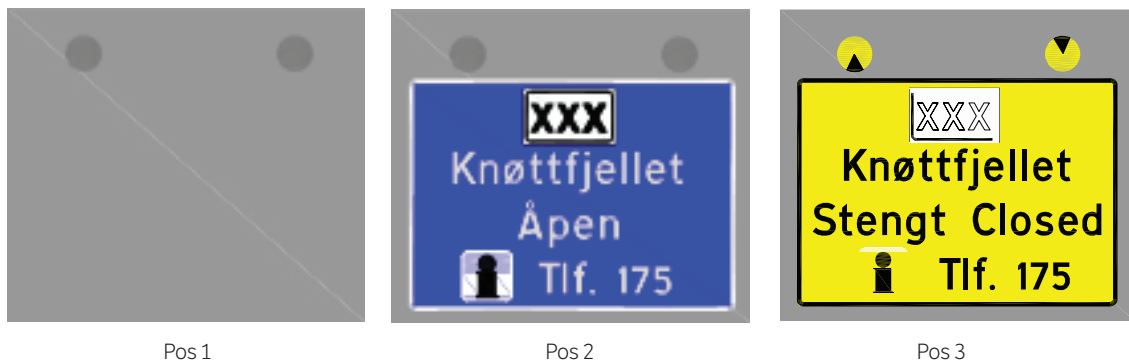
Figur 7.2 Forvarsling av høyfjellsovergang, mekanisk variabelt skilt
