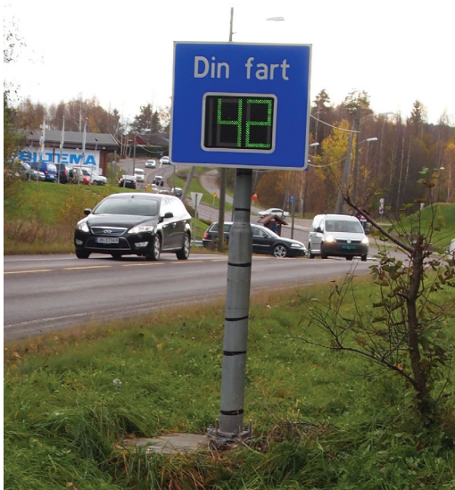
Figur 7.4 Eksempel på utforming av fartsmålingstavle
