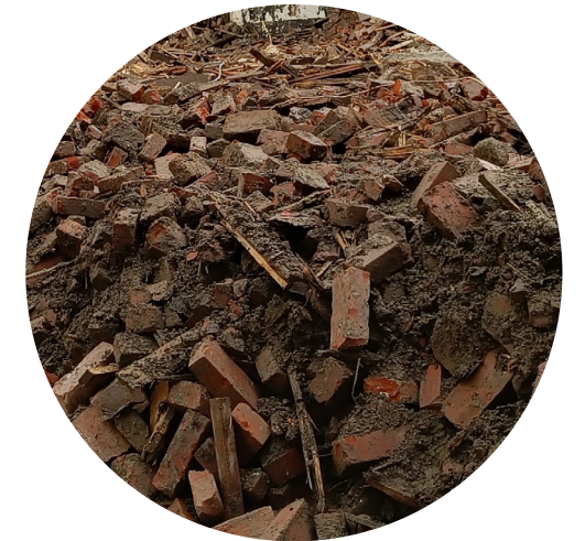
Ombrukstegl fra riveprosjekt - sorteres etter kvalitet og kan brukes til å utbedre vegger og skader i mursteinsfasaden, eller i interiør.
