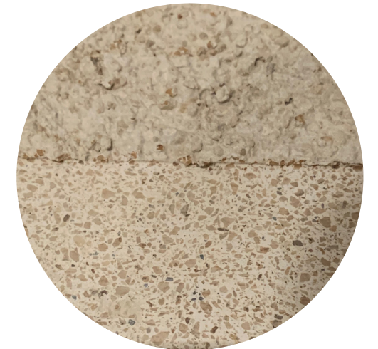
Isolerende puss av kalk og kork. Rå, eller slipt til terrazzo. Fra utstillingen "Ny Nordisk".
