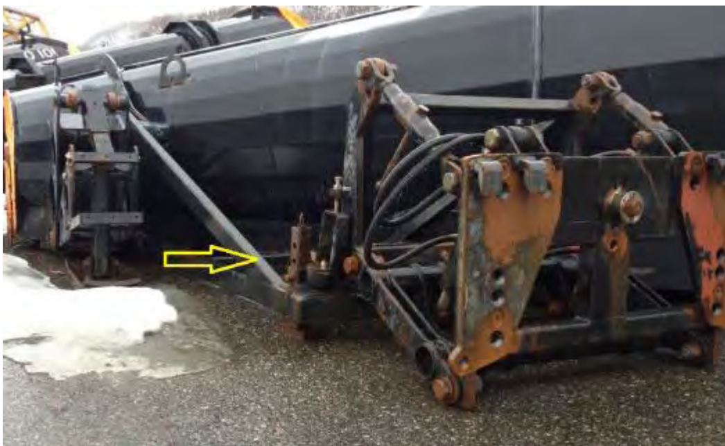
Figur 4-19 Eksempel på parkeringsfot på diagonalplog
