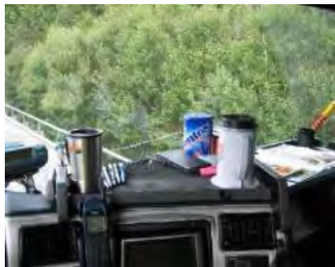
Figur 2-29 Traktor med både plog og frontlaster med påmontert skuffe. I tillegg til frontlaster og eksosrør tar også skuffa betydelig sikt. Gjenstander på ettermontert bord skaper blindsoner (Foto: Statens vegvesen)
