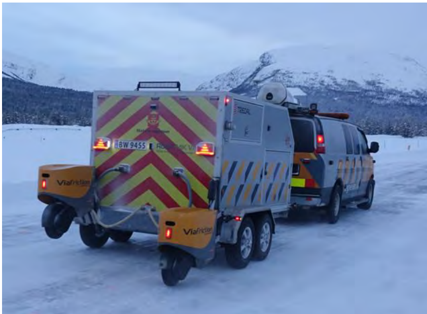
Figur 5-13 Friksjonsmåling på vinterføre med to spors RoAR-måler (Foto: Statens vegvesen)
