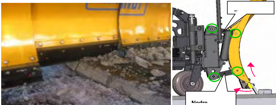
Figur 4-33 Bevegelige plogseksjoner på fortauskant (Kilde: AEBI Schmidt Norge AS)
