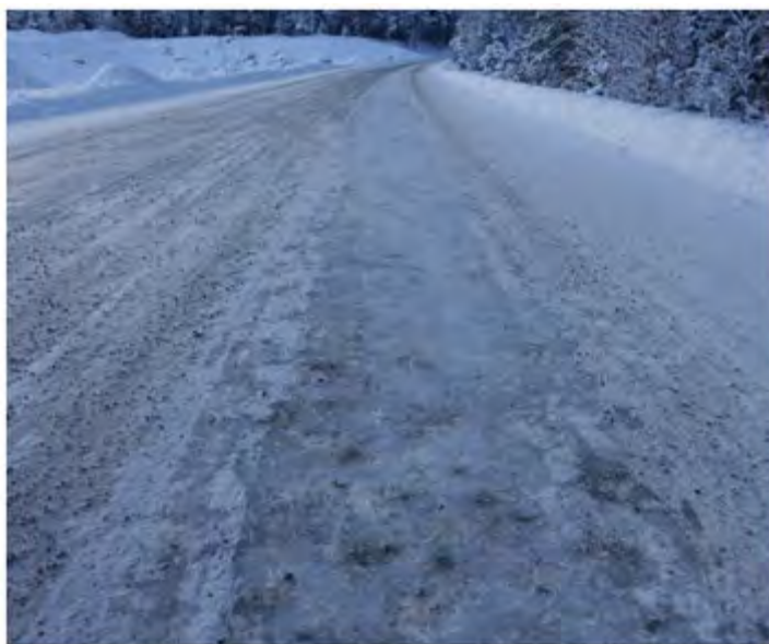
Figur 7-13 Varighet av tørrsandtiltak. Her har ca. 100 personbiler passert etter strøtiltaket. Det er mye sand som ligger mellom hjulsporene, men i hjulspor er det lite igjen. (Foto: Statens vegvesen)
