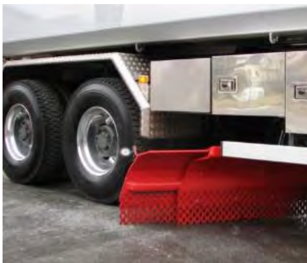
Figur 4-37 Underliggende skjær (Foto: Tellefsdal AS)
