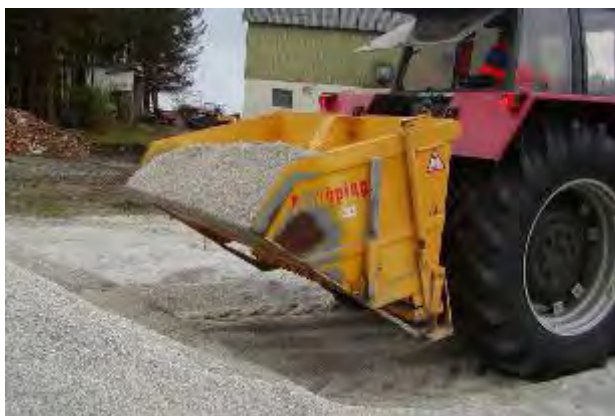
Figur 6-7: Til venstre: Bakmontert selvlastende strøapparat for traktor (Foto: Falköping). Til høyre: Strøapparat med spredetallerken (Foto: Aebi Schmidt AS)
