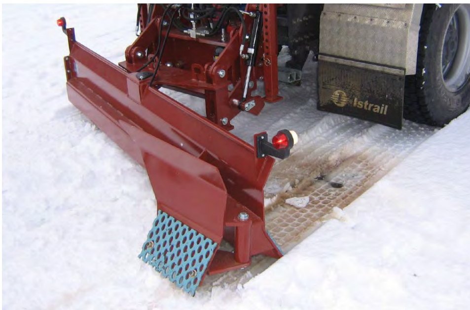
Figur 4-39 Bakmontert skjær på lastebil, viser Bakbattet bakmontert skjær
