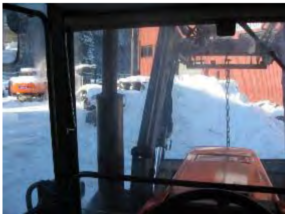
Figur 2-28 Lasteapparatet brukes til å heve og senke brøyteskjæret. Dette skaper ekstra blindsoner. På bildet til høyre står det en person som er skjult av armen på lasteapparatet (Foto: Jahn Ivar Systad)
