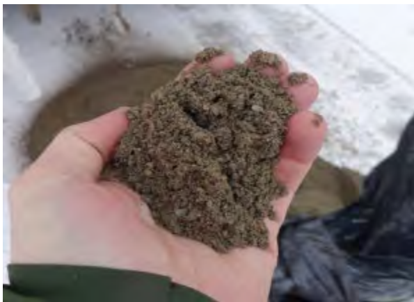
Figur 7-2 Knust naturgrus (Foto: Statens vegvesen) Figur 7-3 Knust fjell (Foto: Statens vegvesen)
