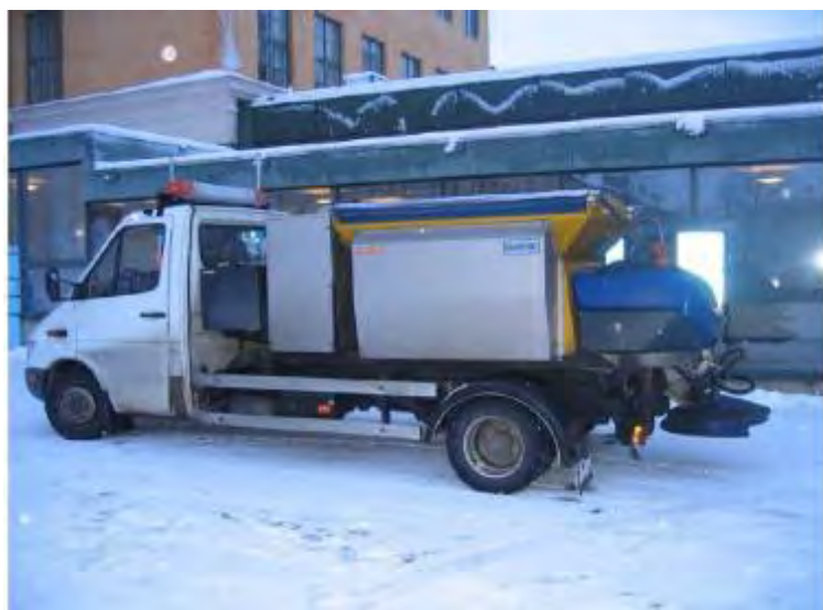
Figur 6-13: Kjøretøy for fastsandspredning på gang- og sykkelareal som er benyttet i Umeå kommune (prototype) (Foto: Anna Niska, VTI Sverige)
