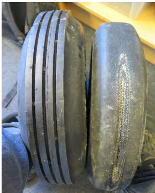
Figur 5-18 Bildet viser et nytt måledekk (til venstre) og et totalt utslitt måledekk (til høyre) (Foto: Viatech AS)
