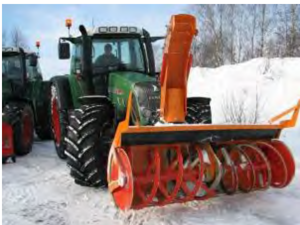
Figur 4-77 Frontmontert snøfres på traktor (Foto: Tellefsdal)
