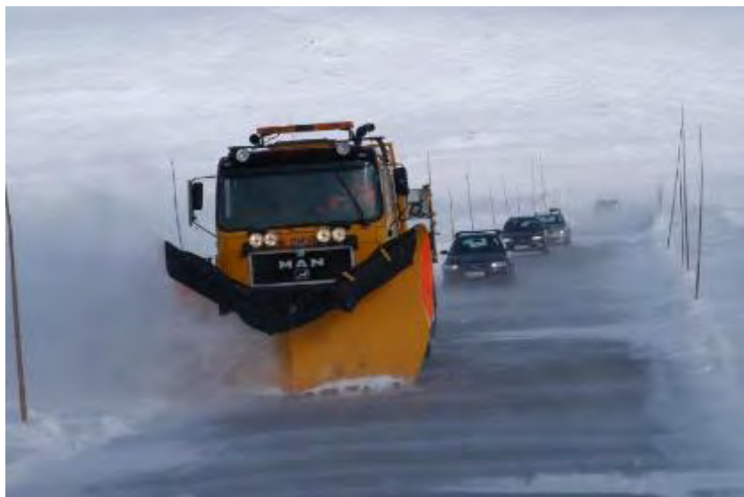
Figur 4-88 Kolonnekjøring (Foto: Statens vegvesen)
