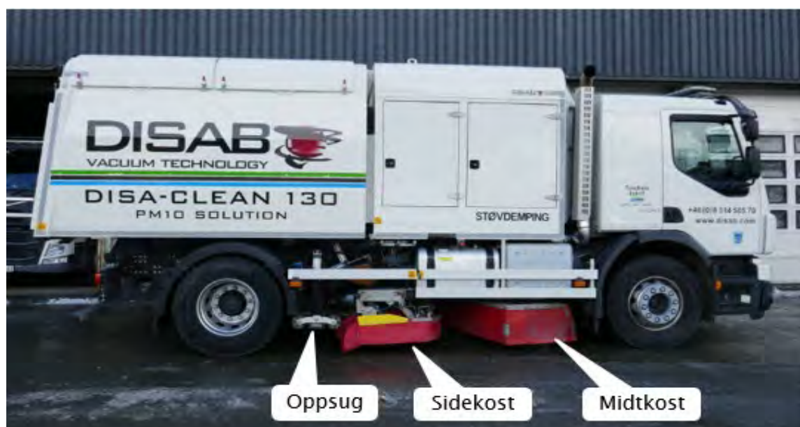
Figur 9-29 Feiebil for rengjøring av vegbane (Foto/Illustrasjon: Statens vegvesen)
