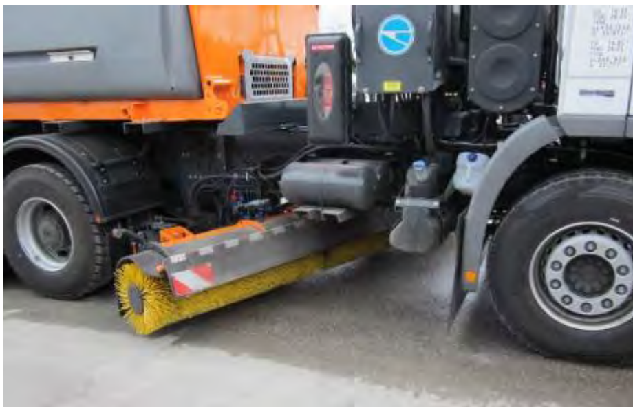
Figur 4-47 Underliggende kost (Gilletta) (Foto: Statens vegvesen)
