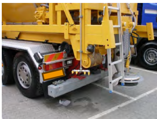
Figur 6-6: Strøapparat med sidedyser for høyhastighetsspredning (Foto: Falköping til venstre og Epoke til høyre)
