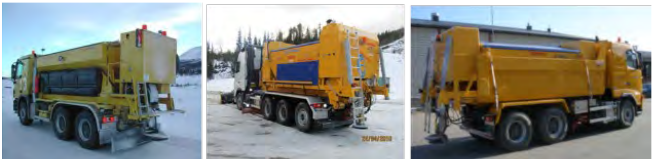
Figur 6-1: F.v.: Rammemontert, krokloftmontert og planfastspent strøpparat med spredetallerken (Foto fra venstre: Torgeir Vaal og Falköping)
