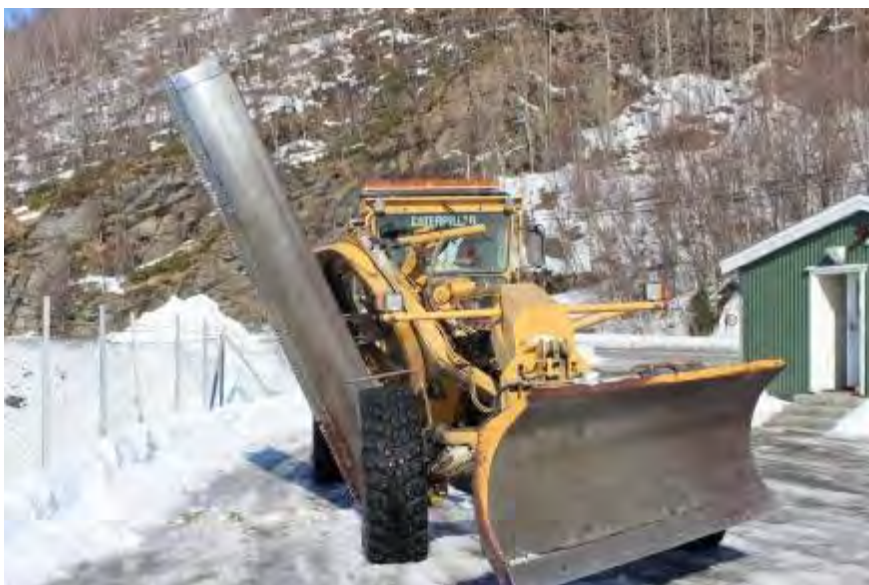
Figur 4-71 Høvel for nedtaking av snøkanter (Foto: Statens vegvesen)
