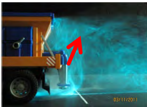
Figur 6-26: Vertikale luftstrømmer bak en lastebil i fart
