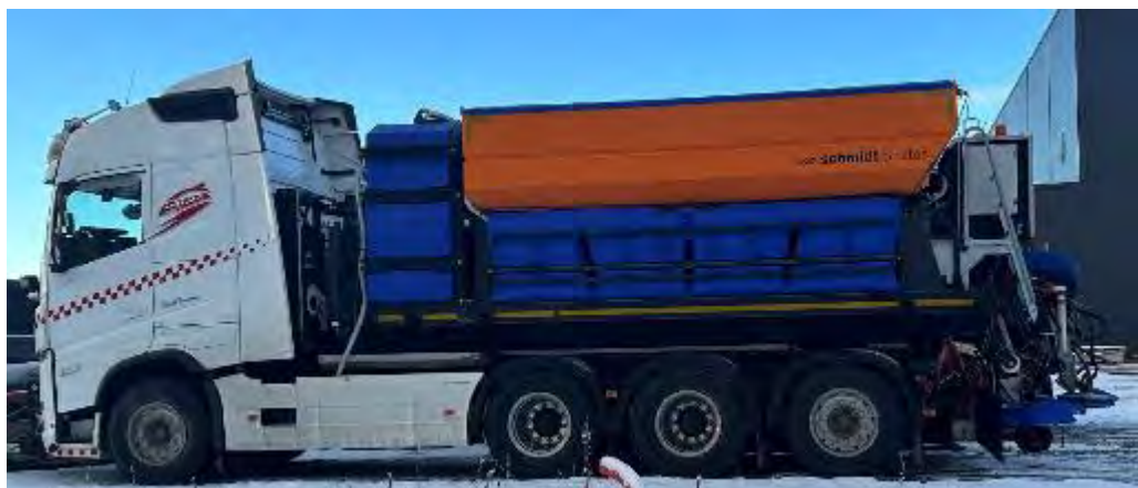
Figur 6-16: Eksempel på bærekjøretøy for strøing. 4-akslet lastebil med fastsand strøpparat (Foto: Aebi Schmidt AS)
