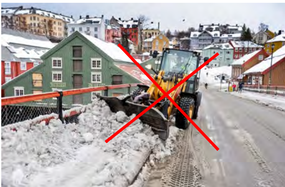
Figur 4-56 Eksempel på kjøretøy som er dårlig egnet til jobben som skal utføres. Maskinen er for tung og bred til brøyting på fortau) (Foto: Statens vegvesen)
