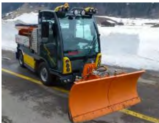
Figur 6-9: Eksempel på utstyr for gang- og sykkelareal med tallerkenspreder (sand/ salt) og frontplog (Foto: Statens vegvesen)
