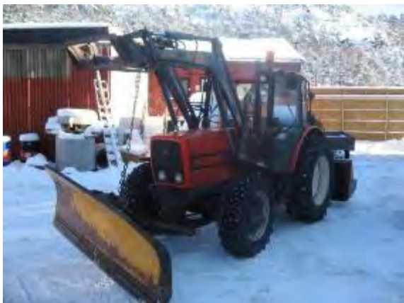
Figur 2-28 Lasteapparatet brukes til å heve og senke brøyteskjæret. Dette skaper ekstra blindsoner. På bildet til høyre står det en person som er skjult av armen på lasteapparatet (Foto: Jahn Ivar Systad)
