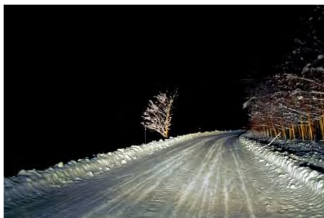
Figur 5-4 Friksjon på snøføre/ tørr is, \mu=0,15-0,30 (Foto: Statens vegvesen)
