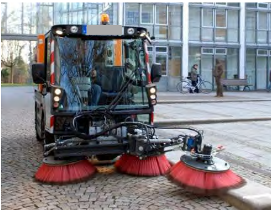
Figur 9-31 Utstyr for renhold av fortau, gang- og sykkelareal og plasser, PM10-sertifisert (Kilde: www.Aebi-Schmidt.no )
