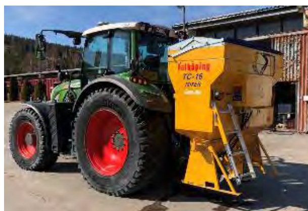
Figur 6-5: Venstre: Fastsand termo-spreder for lastebil med to spredetallerkener (Twin Disc) (Foto: Inge Bolme). Høyre: Fastsand termo-spreder for traktor (Foto: Sigurd Stave Maskin AS)
