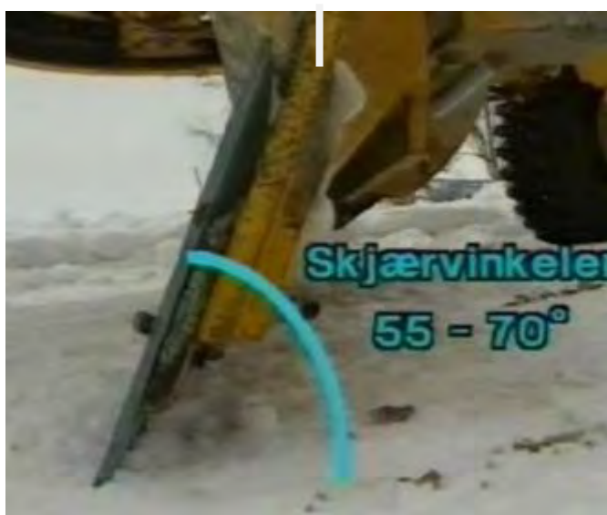
Figur 4-73 Riktig skjærvinkel mellom høvelskjær og underlag
