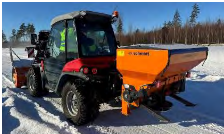
Figur 6-8: Eksempel på vegavhengig bakmontert traktorspreder for tørrstoff. 0,8 m 3 kassevolum. Frontmontert fres (Foto: Aebi Schmidt AS)
