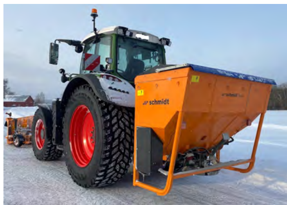
Figur 6-7: Til venstre: Bakmontert selvlastende strøapparat for traktor (Foto: Falköping). Til høyre: Strøapparat med spredetallerken (Foto: Aebi Schmidt AS)
