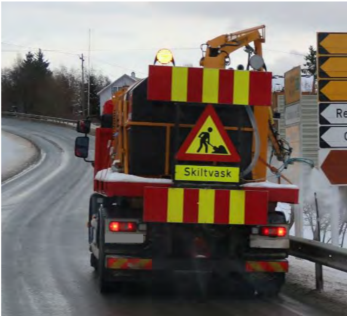
Figur 9-13 Skilt- og kantstolpevask (Foto: Statens vegvesen)
