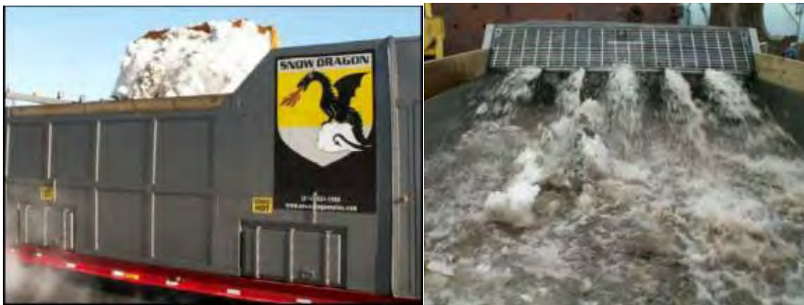
Figur 9-34 Snøsmelter (Foto: Veimas)
