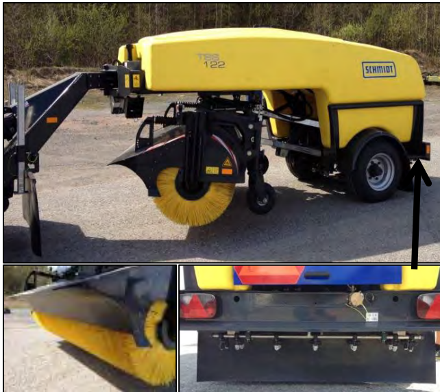
Figur 4-53 Eksempel på traktormontert etterhengende sweeper med saltløsningsspreder (Foto: Statens vegvesen)
