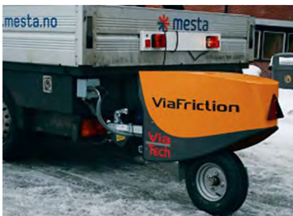
Figur 5-16 ViaFriction-friksjonsmåler, rammemontert (Foto: ViaTech)
