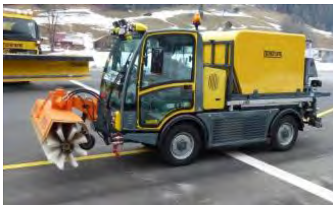
Figur 6-10: Eksempel på utstyr for gang- og sykkelareal med frontmontert kost og dysespreder (Foto: Statens vegvesen)
