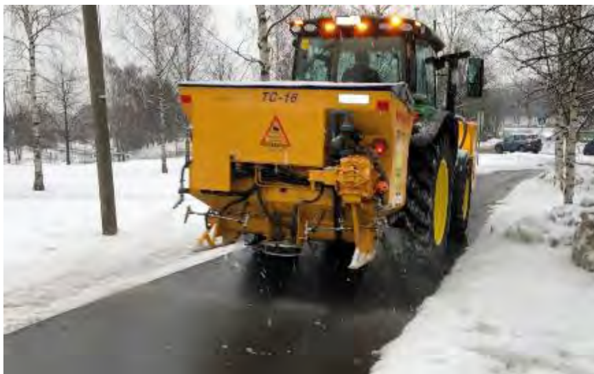
Figur 6-14: Bakmontert kombistrøpparat for tørrstoff med/ uten befuktning og saltløsning (Foto: Sigurd Stave Maskin AS)
