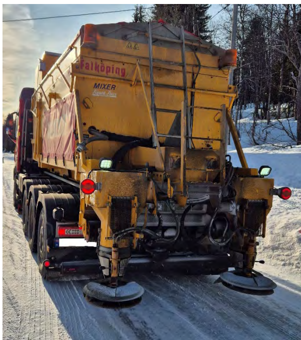
Figur 6-5: Venstre: Fastsand termo-spreder for lastebil med to spredetallerkener (Twin Disc) (Foto: Inge Bolme). Høyre: Fastsand termo-spreder for traktor (Foto: Sigurd Stave Maskin AS)
