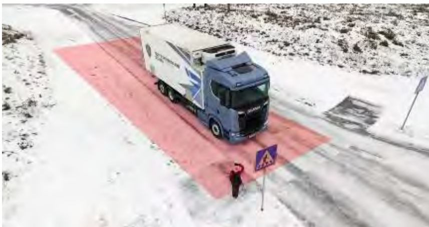
Figur 2-30 Blindsoner for lastebil (Illustrasjon: Norsk Lastebileier-Forbund)
