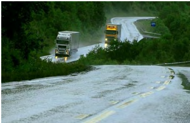
Figur 5-7 Friksjon på våt veg, \mu=0,40-0,90 (Foto: Statens vegvesen)
