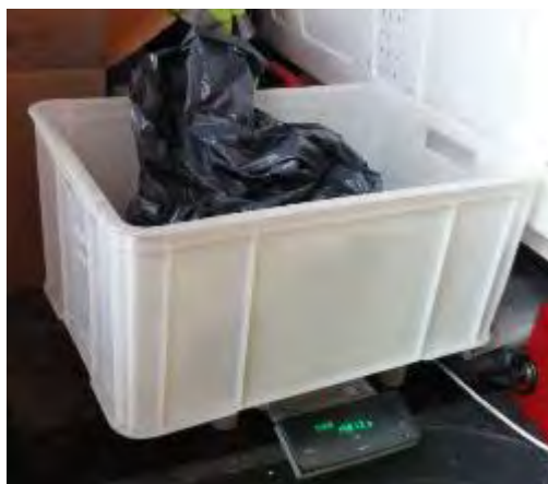
Figur 6-22: Kontroll/kalibrering av spreder med oppsamling og veiing (Foto: Statens vegvesen)
