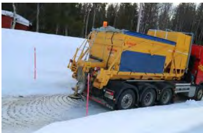
Figur 7-9 Fastsand termo under uttesting og påfylling av vann (Foto: Veidekke)
