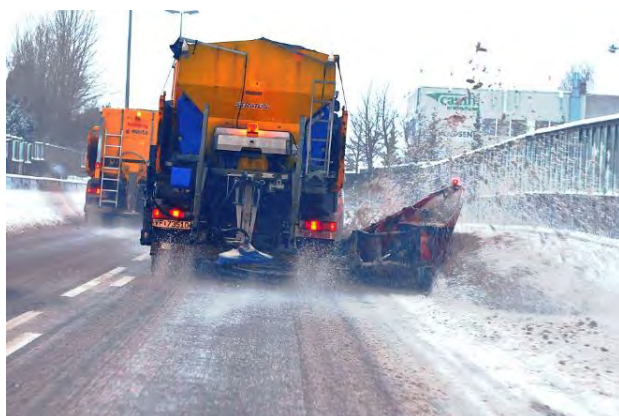
Figur 8-5 Anti-kompaktering – Salting i forbindelse med snøvær (Foto: Statens vegvesen)
