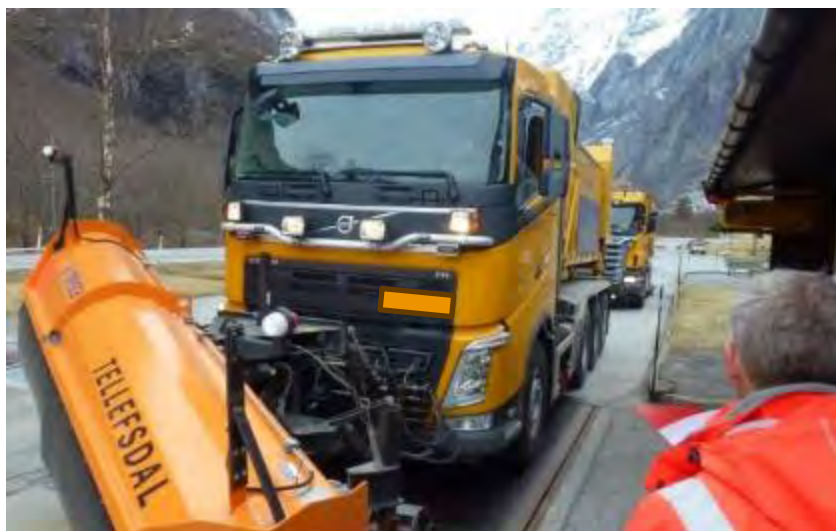
Figur 6-21: Veiing av kjøretøy før og etter strøing (Foto: Statens vegvesen)
