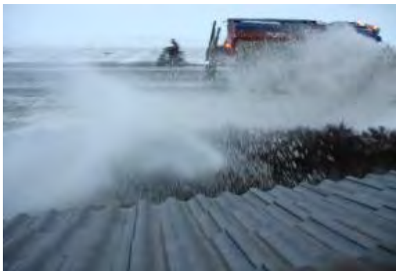
Figur 2-16 Bilde som viser brøyting i høy hastighet, hvor snø kommer i stor fart inn på naboeiendom (Begge foto: Bengt Gullbrå)
