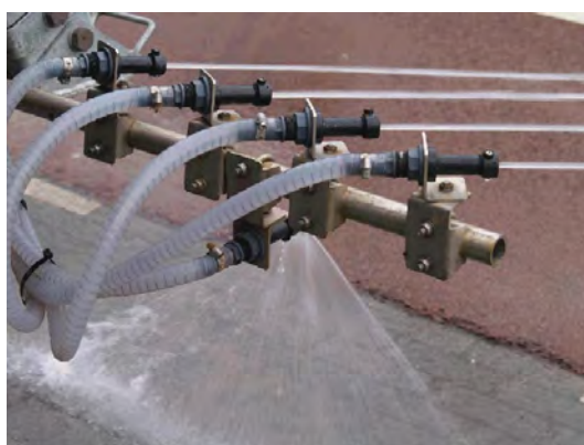
Figur 6-6: Strøapparat med sidedyser for høyhastighetsspredning (Foto: Falköping til venstre og Epoke til høyre)
