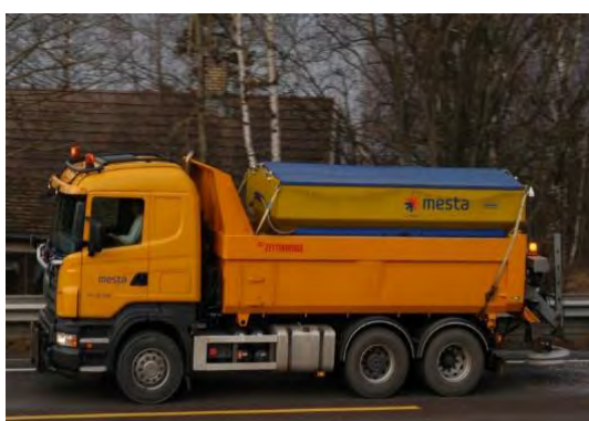
Figur 8-7 De-ising – Salting for å fjerne et is-/ eller snødekke (Foto: t.v. Torgeir Vaa, t.h. Håkon Aurlen)
