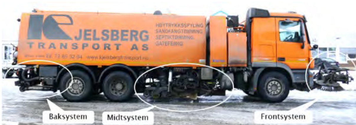
Figur 9-30 Feie-/spyleenhet for vegbane og kantstein (Foto/Illustrasjon: Statens vegvesen)
