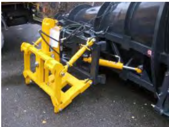
Figur 4-27 Diagonalplog med hydraulisk skråstilling (Foto: GMI)
