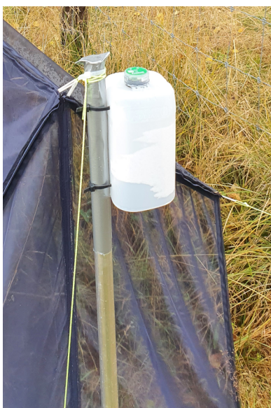
Figur 25. Temperatur- og lysmåler av typen Hobo MX2202 (grønn knapp). Loggeren er plassert i sol og data kan hentes ut med blåtann og deretter til en skyløsning.
