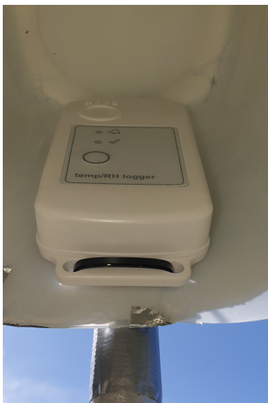
Figur 24. Temperatur- og luftfuktighetslogger av typen Hobo MX2301A. Loggeren er plassert i skygge og data kan hentes ut med blåtann og deretter til en skyløsning.
