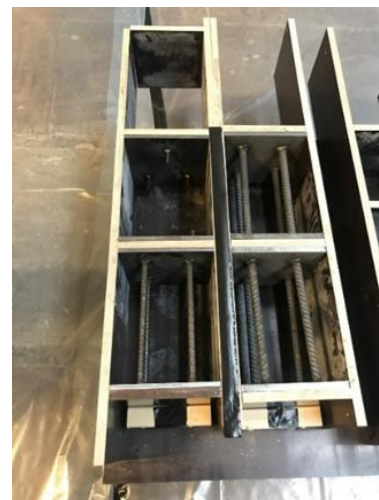
c) Forankringsplater og armering på prismer (2020)
