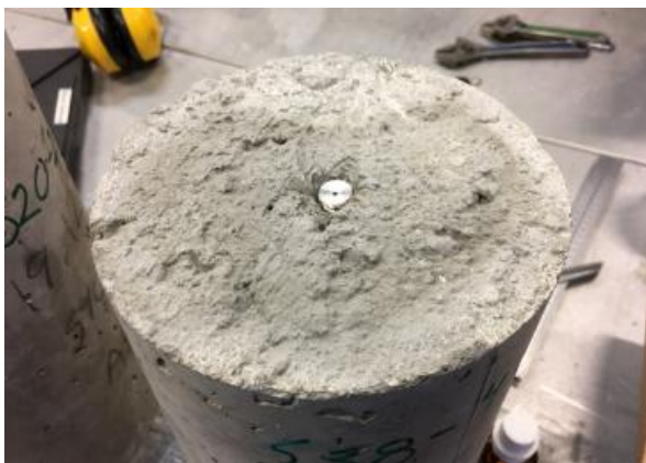
b) Målepunkter av messingbolter limt i borede hull
