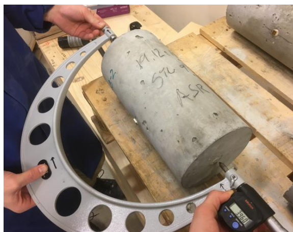
b) Bueekstensometer brukt til målinger på sylindere
