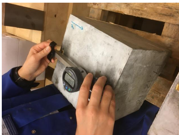
a) Digitalt ekstensometer brukt til målinger på kuber og prismer
