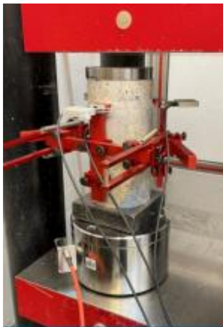
Figur 3-8: Rigg ved testing av SDT (Foto: Tore Myrland Jensen)
