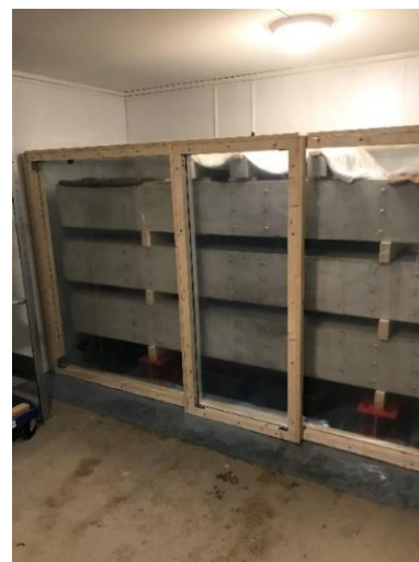
c) Bjelkene lagret i teltet i 38 °C-rommet
