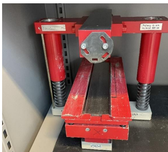
Figur 3-7: Alpha Form test prøvemaskin benyttet til spaltestrekkeforsøkene, Foto: Erik Johansen
