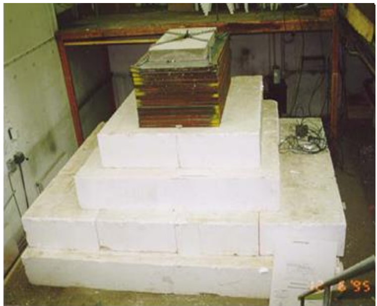
Figur 19. Modellforsøk med EPS blokker for å se på deformasjon, kryp og spenningsfordeling. (Foto: R. Aabøe)
