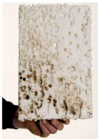
Figur 3.11: EPS angrepet av insekter (skadedyrkontroll.biz, 2011).
