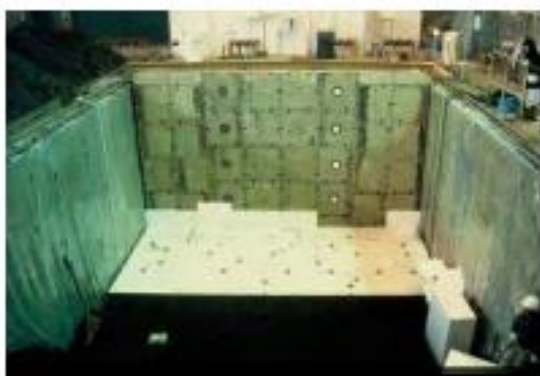
Figur 40. Måling av jordtrykk på en stor støttemur i laboratoriet. Foto; Hideki Tsukamoto
