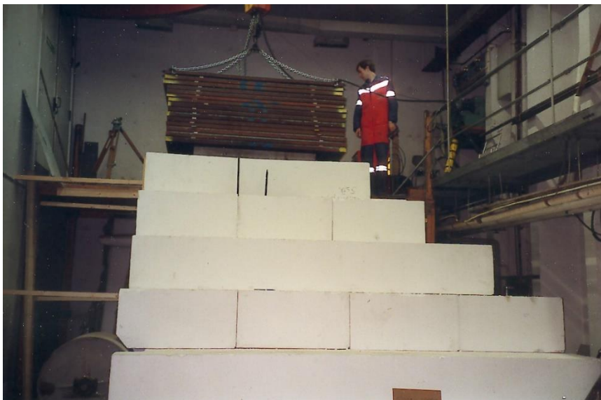
Figur 2. Krypforsøk på en fylling av EPS i forsøkshallen på Veglaboratoriet. Hermann Bruun styrer pålastningen. Foto: Roald Aabøe, Statens vegvesen
