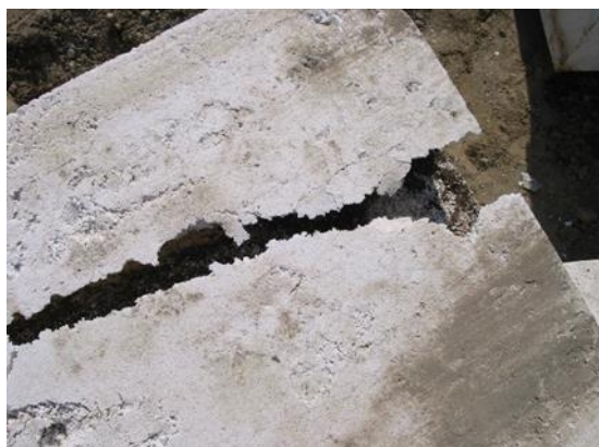
Figur 6. EPS må beskyttes mot kjemisk og mekanisk påvirkning. Foto R. Aabøe, Statens vegvesen
