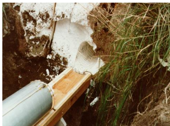
Figur 7. Utgraving for prøveprogrammet med gravemaskin og motorsag og med varmetråd.. Foto fra Vd rapport 33 og masteroppgave Brattensborg G.
