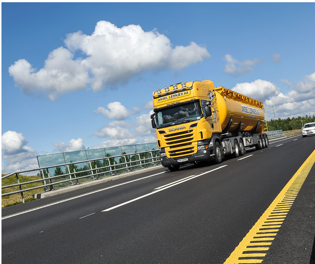
Profilert veioppmerking skaper «rumlelyd» og risting i rattet når den kjøres på. Her med utformingstypen kammflex. Foto: Knut Opeide, Statens vegvesen.
