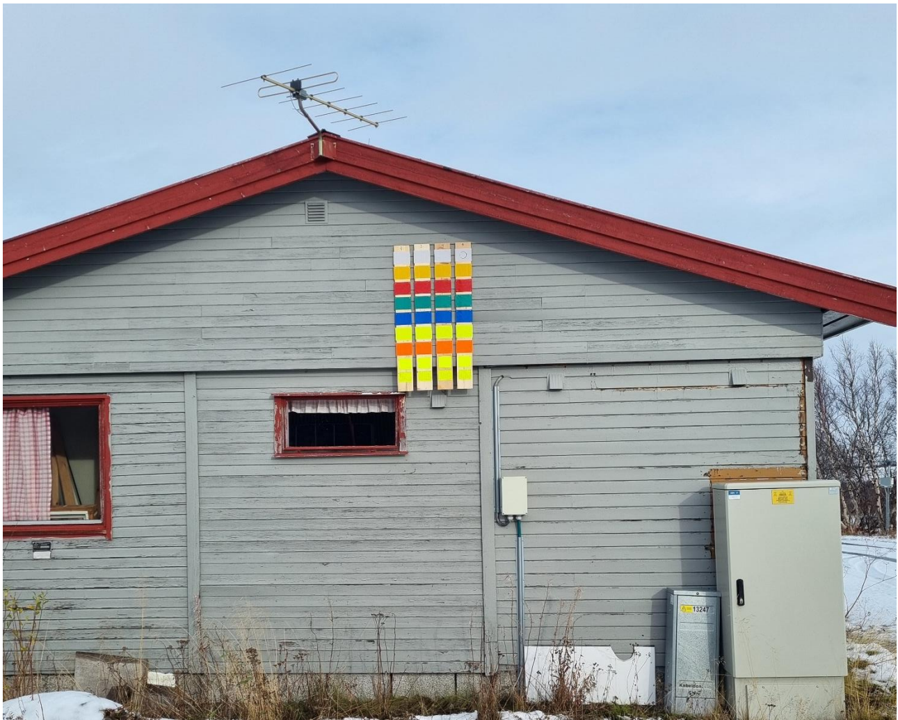
Figur 24: Prøvereflekser montert på fjøler opphengt for langtidstesting ved Sørrelva Brøytestasjon. Ovenfra og ned: Hvit_o, Gul_o, Rød_o, Grønn_o, Blå_o, Gul_f, Oransje_f, Gul_f** og Gul_f*.
