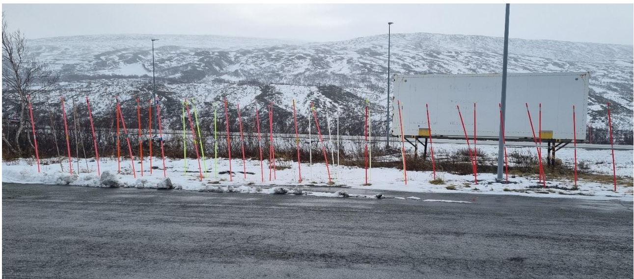
Figur 25: Prøvefelt langtidstest av egenskaper refleks og fluoriserende brøytestikk. Bilde fra Saltfjellet 2. oktober 2024.
