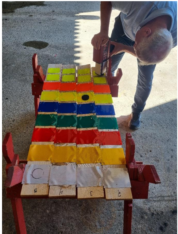
Figur 23: Retrorefleksjonsmåling på plant underlag
