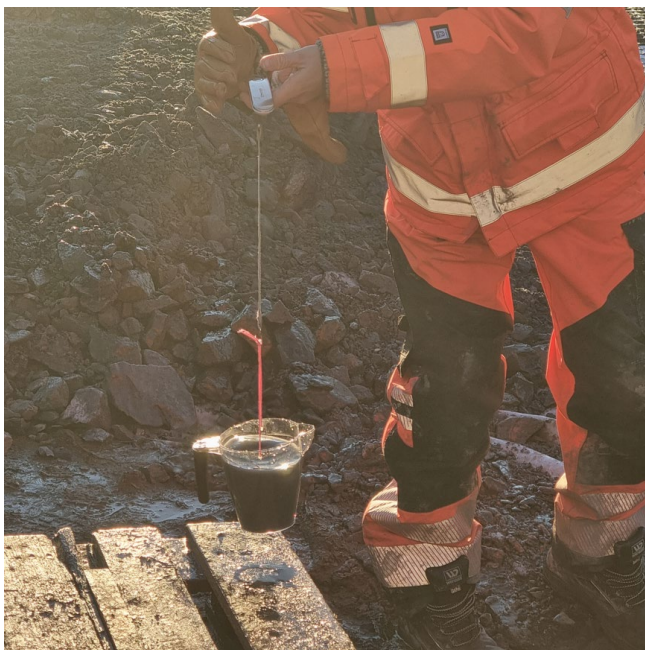
Figur 28 Bilde av veiing av vann med litermål og enkel bagasjevekt. Foto: Daniel Jergling
