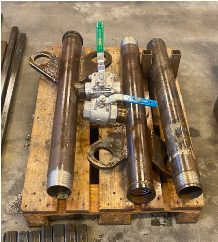
Figur 21 pumperør med påsveiset flens, heiseører og gjengetapp til lufteventil. Foto: Bjørn Wold.
