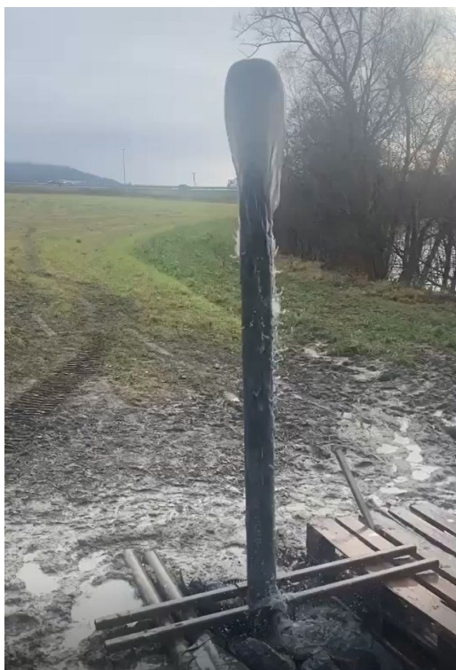
Figur 13 Til venstre: bilde av lekkasje med 2 m ekstra foringsrør over terreng, dvs. stighøyde på ca. 2,3 over terreng. Til høyre: Etter 15 minutter strømmer vannet på utsiden av røret. Foto: Bjørn Wold.
