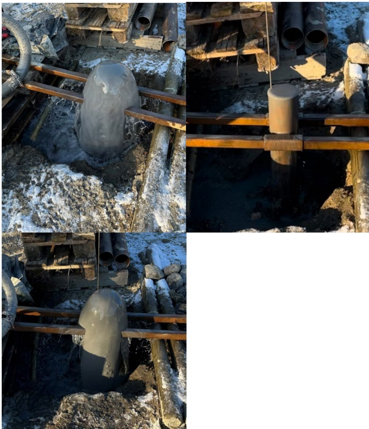
Figur 17 bilde øverst til venstre viser utstrømning før loggeforsøk, bilde øverst til høyre viser utstrømning da det skjedde en kollaps, bildet nederst viser utstrømningen etter ca 10 minutter. Her har vannstrømmen tatt seg opp, men det er tydelig mer utvasking. Foto: Heidi Kjennbakken.
