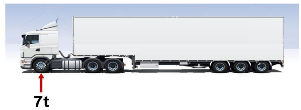
Figur 7: Eksempel på 6-akslet semitrailer som kan benyttes ved automatisk kalibrering av WIM-installasjoner /2/.
