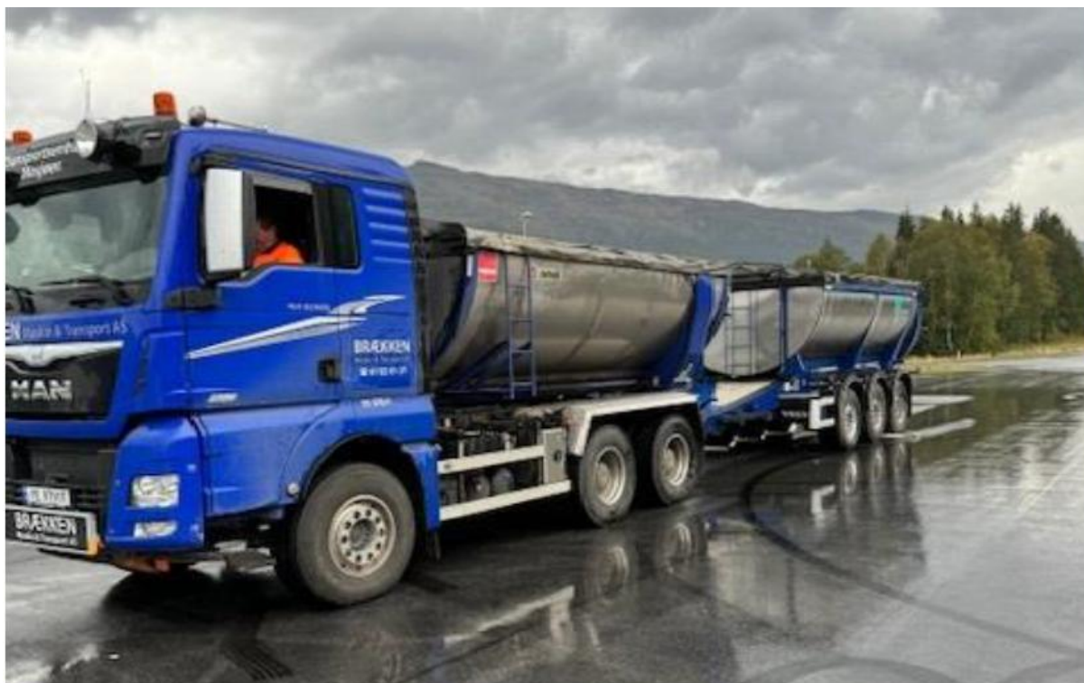
Figur 6: Kjøretøyet som ble benyttet ved kalibrering og kontroll av WIM-installasjonen på E6 ved Mosjøen i 2024.
