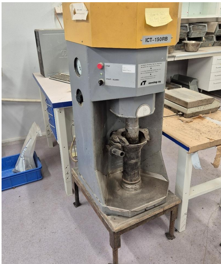
Bilde 3 Gyrator ved NTNUs laboratorium. Foto: Trond Østen, Statens vegvesen
