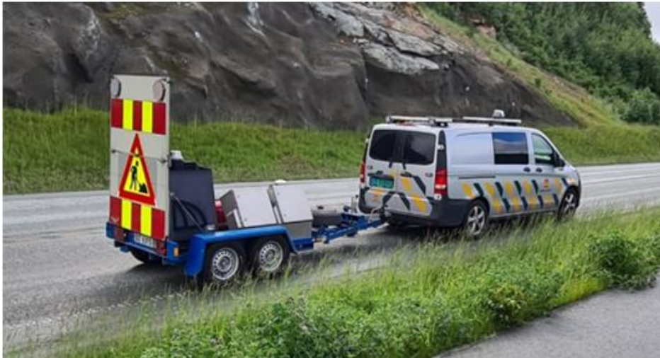
Figur 1. Fallodd (Falling Weight Deflectometer, FWD) utstyret som brukes på laboratorieseksjonen, fagressurs drift og vedlikehold
