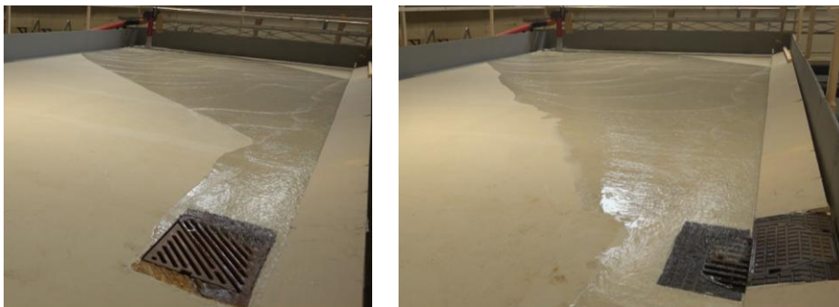
Figur 9 Test 7 (rennestensluk) og test 16 (kjeftesluk). Foto NTNU (2025)
