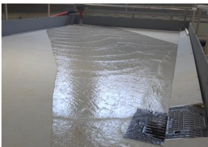
Figur 5 Test 1 (rennestensluk), test 13 (kjeftesluk) og test 23 (kjeftesluk med vegmerking). Foto NTNU (2025)
