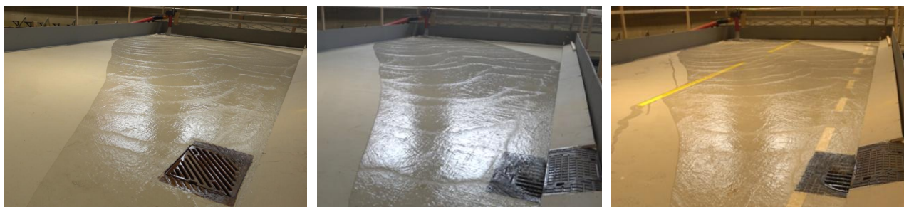
Figur 8 Test 3 (rennestensluk), test 14 (kjeftesluk) og test 24 (kjeftesluk med vegmerking). Foto NTNU (2025)
