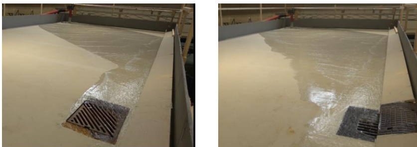
Figur 6 Test 5 (rennestensluk) og test 15 (kjeftesluk). Foto NTNU (2025).
