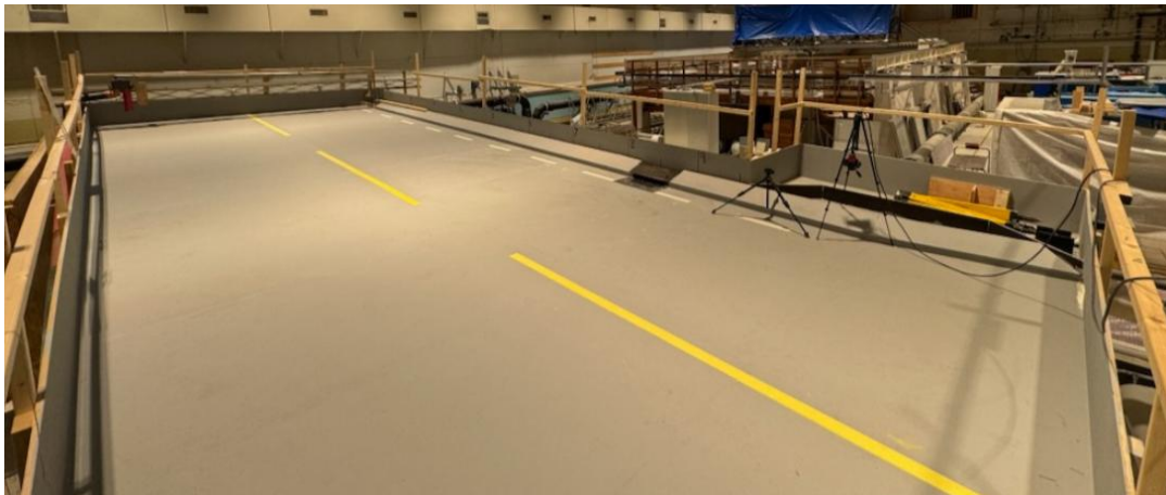
Figur 1 Bildet viser test-riggen på laboratoriet hos NTNU. Riggen er 4,8 meter bred og 12 meter lang.
