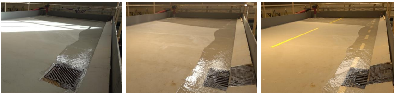
Figur 7 Test 9 (rennestensluk), test 17 (kjeftesluk) og test 20 (kjeftesluk m. veimerking). Foto NTNU (2025)
