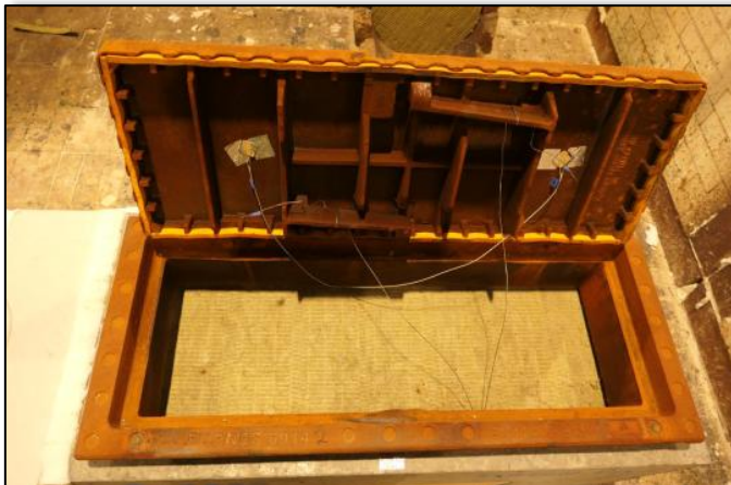
Figur 32 Bildet viser trekkekum TK2 Tunnel og støpejernslokk med 10 cm isolasjon før igangsettelse av test. På undersiden av lokket 2 stk. temperatursensorer. Foto: RISE Fire Research
