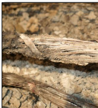
Figur 23 Bildene over viser hvordan trekkekum TK2 Tunnel har fått store skader etter gjennomført test. Foto RISE Fire Research.
