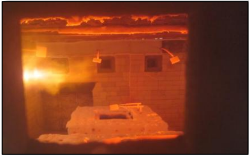
Figur 8 Bildet viser varmepåvirkning på lokk. Foto: RISE Fire Research.
