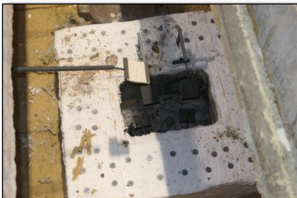
Figur 18 Bildet viser tilstand på kummen etter test. Foto: RISE Fire Research.
