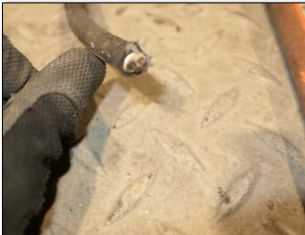
Figur 26 Bildene viser hvordan TK2 trekkekum er skadete etter test med 3cm isolasjon. Foto: RISE Fire Research
