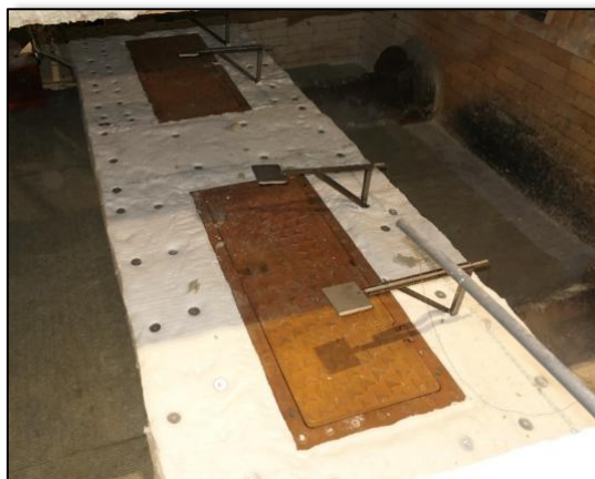
Figur 21 Bildet viser kummene før test isolert med lettbetong og AES fiberisolasjon. Foto: RISE Fire Research.
