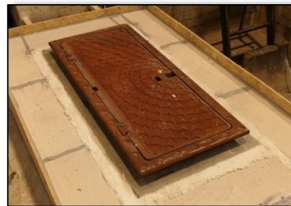
Figur 36 Bildet viser trekkekum TK2 Tunnel med påstøp av asfalt på vestre og påstøp med betong til høyre. Bildet til høyre viser trekkekummen ute påstøpen er etablert. Foto: RISE Fire Research.
