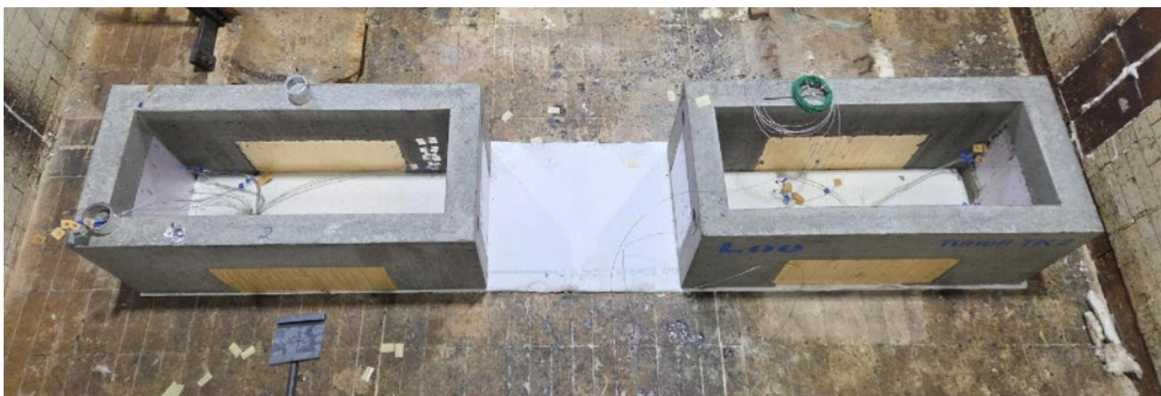
Figur 4.21 Fotografi av trekkekum 3a (venstre) og 3b (høyre) før de ble isolert utvendig.
