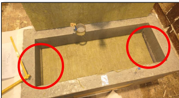
Figur 30 Bildet viser glippe mellom isolasjon og kummens kortsider som kan ha bidratt til noe varmetilførsel.
