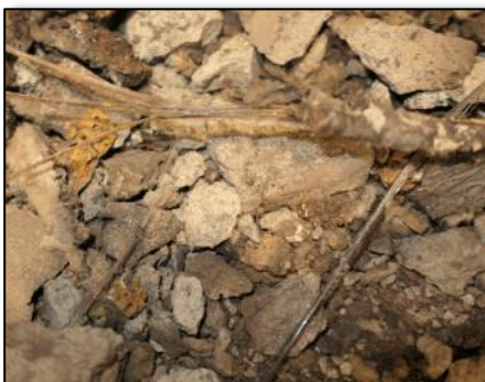
Figur 23 Bildene over viser hvordan trekkekum TK2 Tunnel har fått store skader etter gjennomført test. Foto RISE Fire Research.
