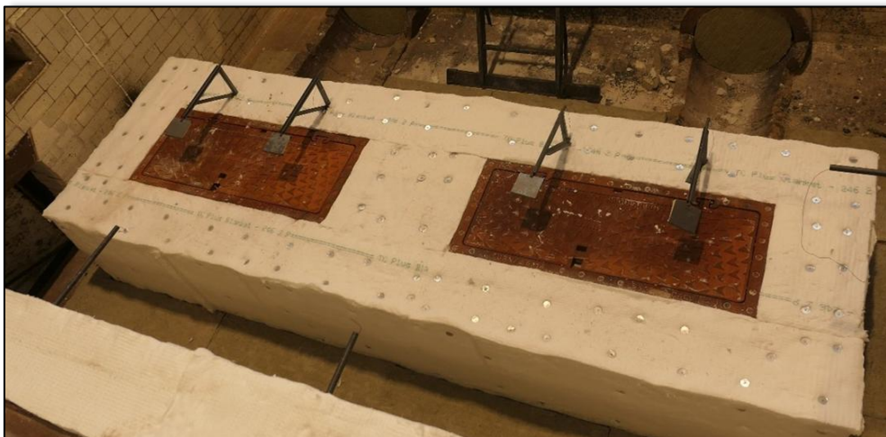
Figur 28 Bildet viser de to kummene med montert støpejernslokk før testene skal igangsettes. Foto: RISE Fire Research.
