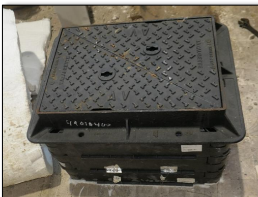
Figur 13 Bildet viser HDPE-trekkekum med støpejernslokk. Foto: RISE Fire Research.
