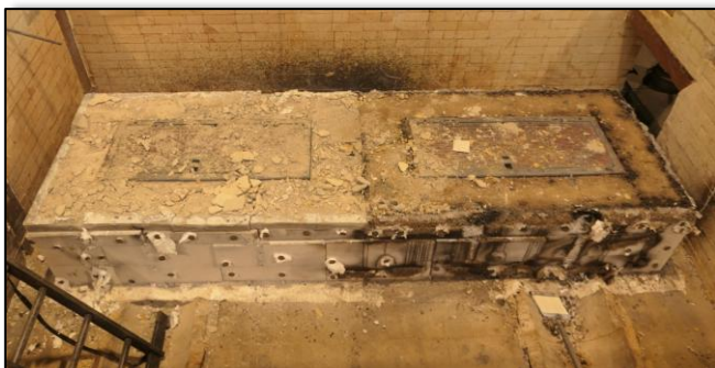
Figur 40 Bildene viser tilstand på oppi trekkekummen etter gjennomført test 4b. Foto: RISE Fire Research.
